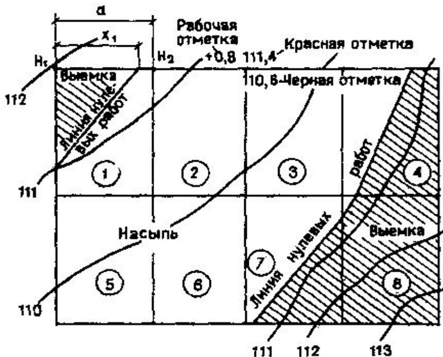
*Схема разбивки местности при определении объемов планировочных работ методом четырехгранных призм. Цифры в кружках — номера фигур*
