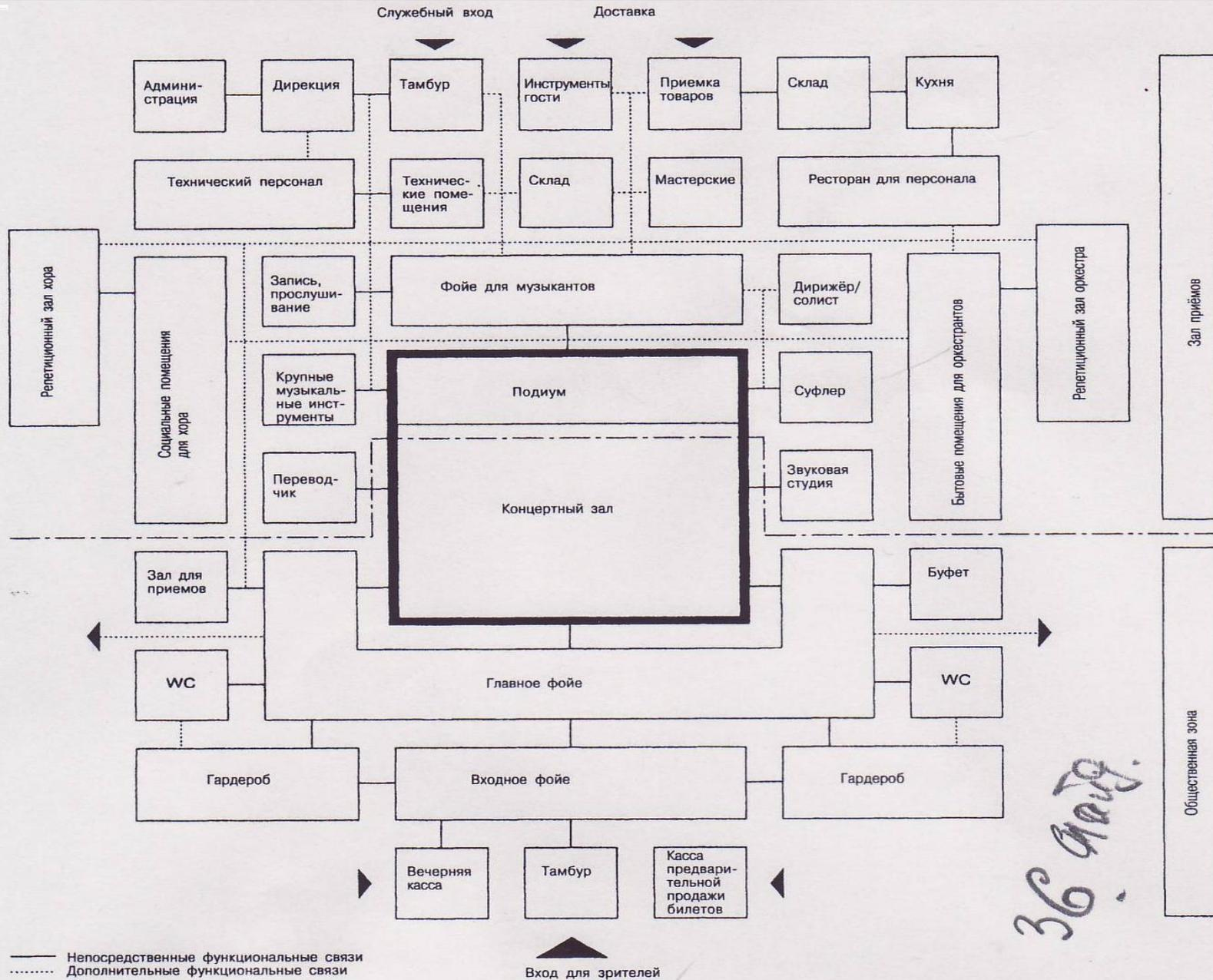
(1) Функциональная схема концертного здания с одним залом [01]
