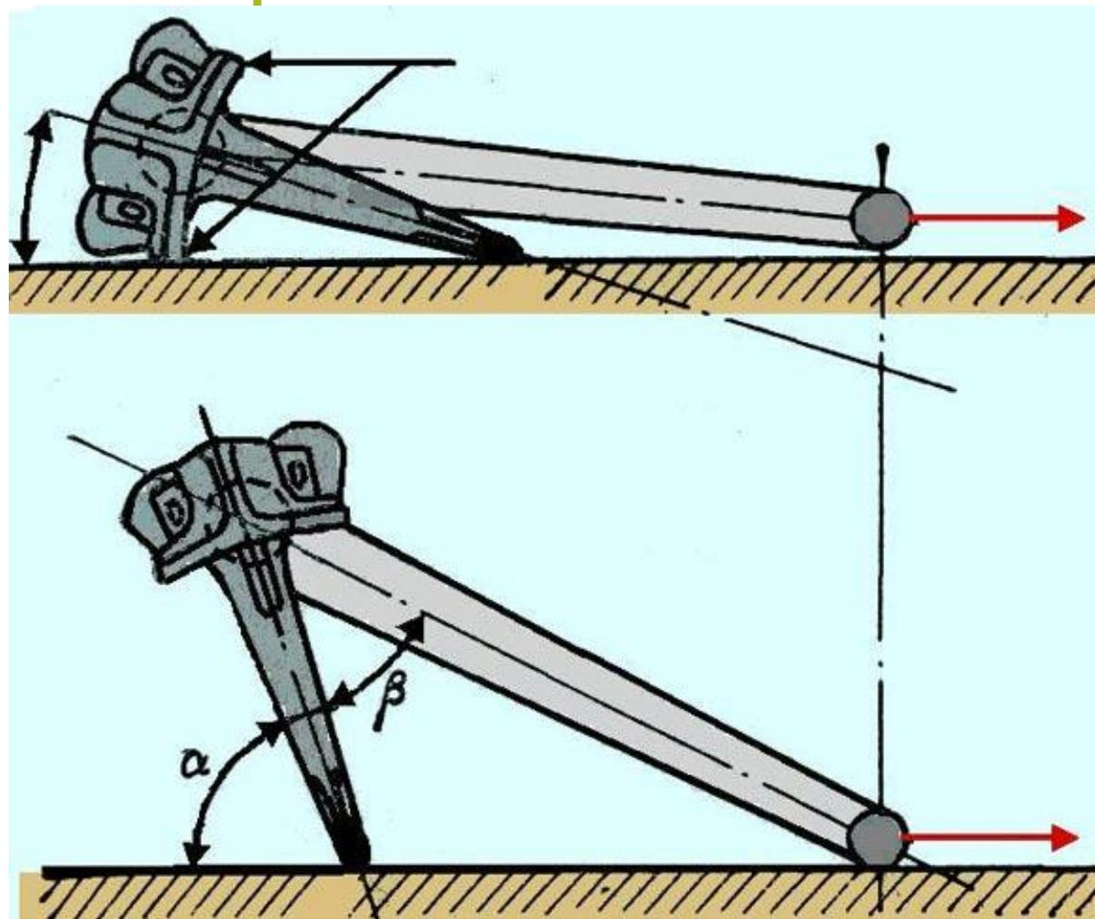
Для выполнения основного назначения становой судовой якорь должен обладать хорошей держащей силой, при этом быстро забирать грунт, а также повторно входить в грунт после срывов.
