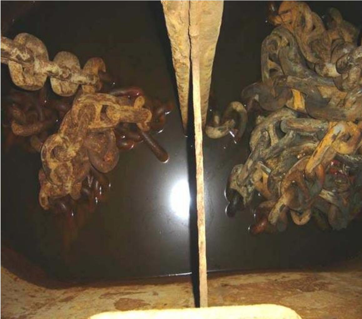
Цепной ящик Служит для хранения якорной цепи. Его размеры должны обеспечивать само укладку цепи. Для направления движения якорной цепи от звездочки брашпиля к цепному ящику устанавливают цепную трубу
