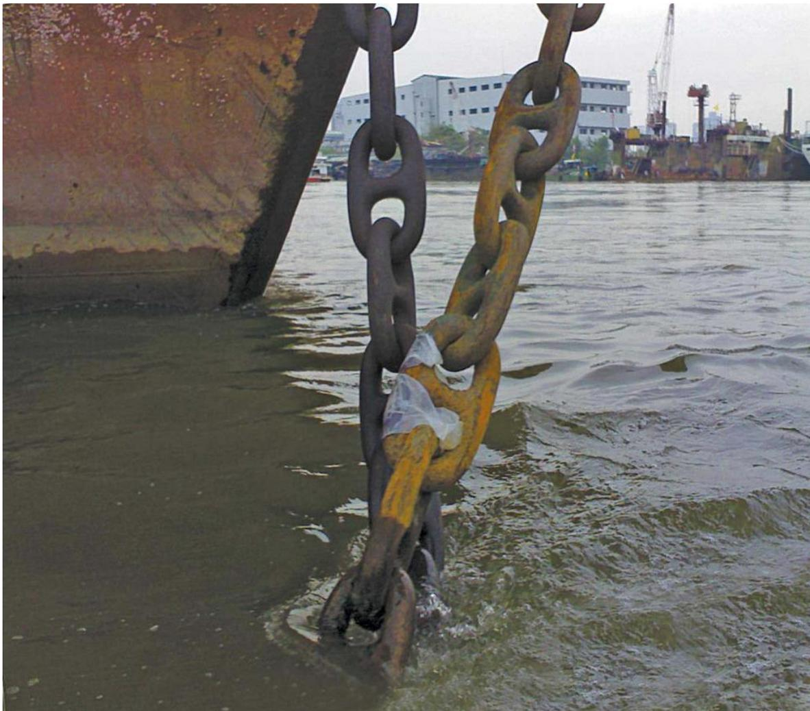
Держащая сила якоря передается судну через якорный канат, один конец которого прикреплен к якорю, а другой крепится на судне.
