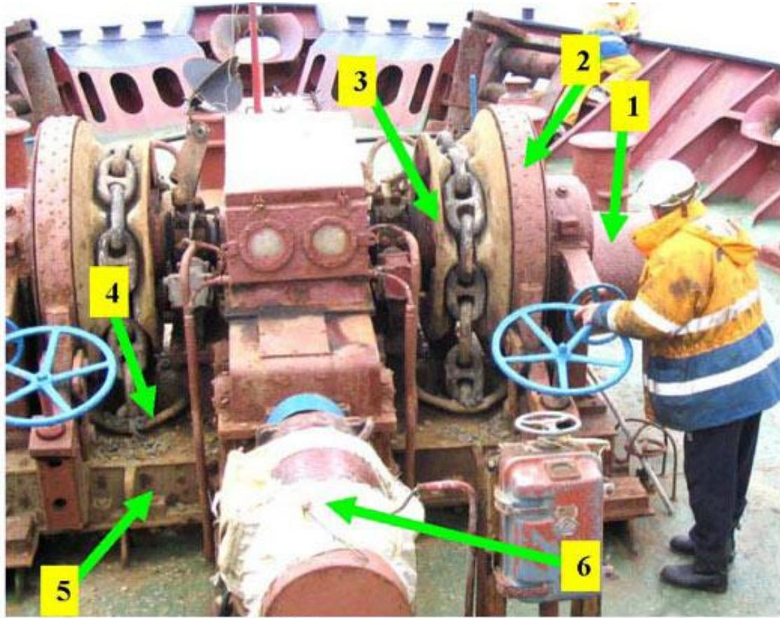
Подъемные механизмы якорного устройства бывают с горизонтально расположенным ведущим валом – брашпили, с вертикально расположенным – шпили и якорно-швартовные лебедки.
