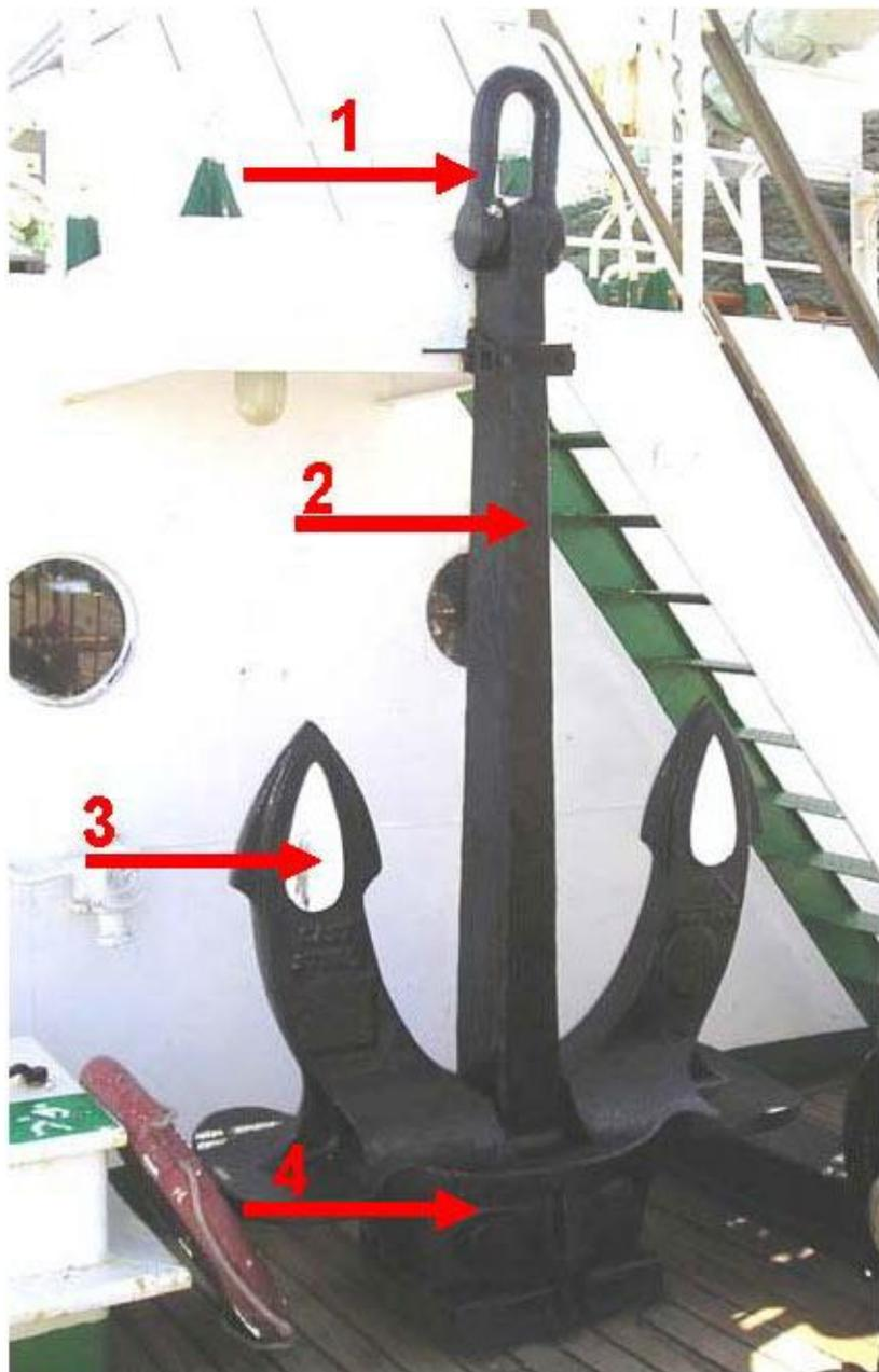
Якорь создает держащую силу, способную противостоять силе ветра и течения, зарываясь лапами в грунт. Самоходные суда имеют носовые якоря – становые и кормовой якорь – стоп-анкер
