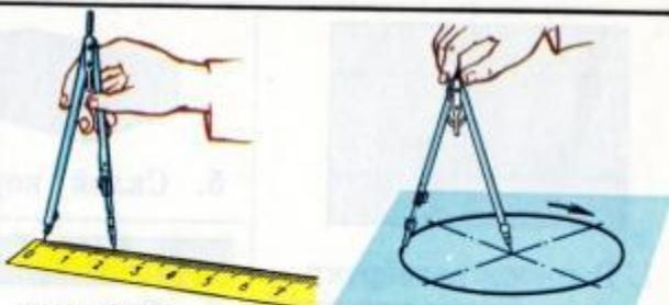
Разметка окружности диаметром 40 мм.
