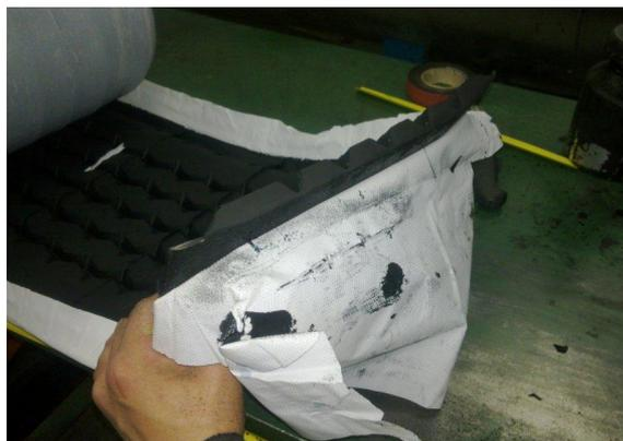
□ затем торцы ленты обрабатывают клеем и, дав высохнуть клею, наносят слой сырой резины.
