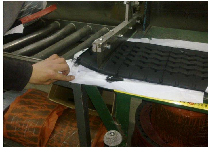
? производится шерохование торцов ленты воздушной машинкой;
