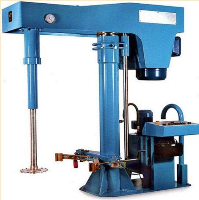
Диссольвер оснащен быстроходной мешалкой фрезерного типа, а скорость вращения можно регулировать. Благодаря этому можно наиболее оптимально организовывать производственный процесс.
