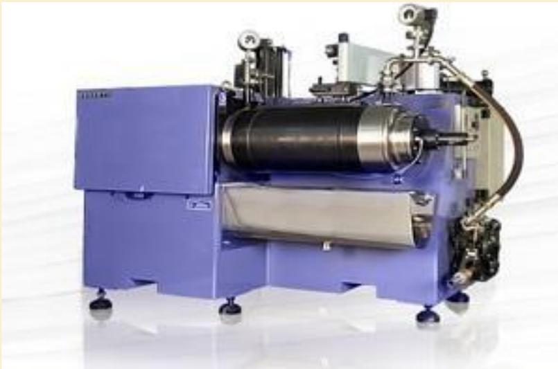
копировальных красок для бумаг, графитных дисперсий и др. У бисерной мельницы высокая производительность. Несколько разных видов диссольтверных дисков обеспечивают высокую качественную переработку сырья.
