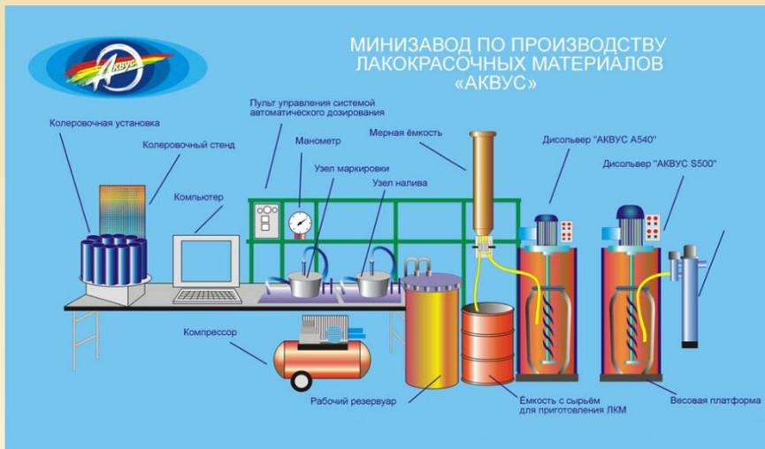
В процессе диспергации происходит тонкое измельчение жидких или твердых тел. Этот метод используется для получения аэрозолей, суспензий, порошков и эмульсий.
