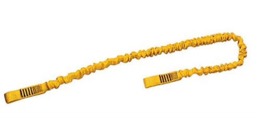
Пояс ПЛ с амортизатором как средство индивидуальной защиты от падения с высоты по условиям безопасности используется на высоте над уровнем грунта или опорной поверхности, указанной в технической документации изготовителя, учитывая длину раскрытия амортизатора. Крепление карабином стропа пояса за опору следует выполнять по возможности не ниже уровня крепления стропа к наспинному или нагрудному страховочному узлу зацепления пояса, но в любом случае – не ниже уровня ступней ног.
