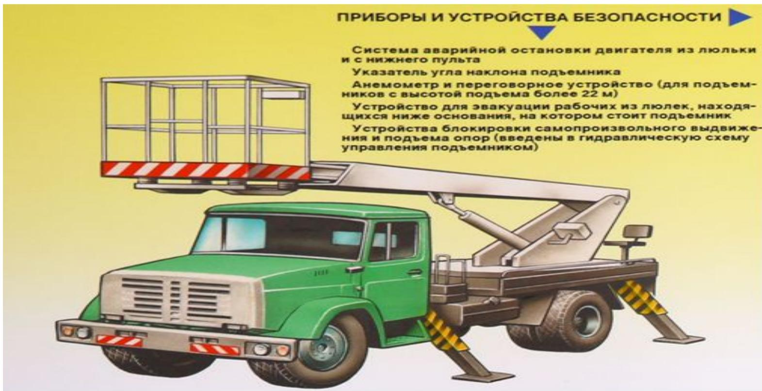
Подниматься работникам в рабочую платформу (люльку) подъемников разрешается только после установки автомобиля на выносные опоры, а в рабочую платформу (люльку) телескопического подъемника - только после установки его выдвижной части вертикально с фиксацией ее в таком положении.
