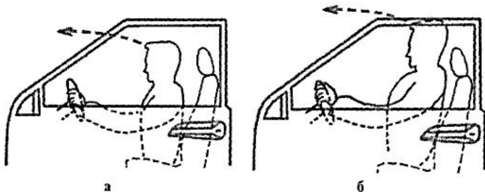
**Рисунок 4 – Соотношение пропорций тела водителя с габаритами салона автомобиля:
