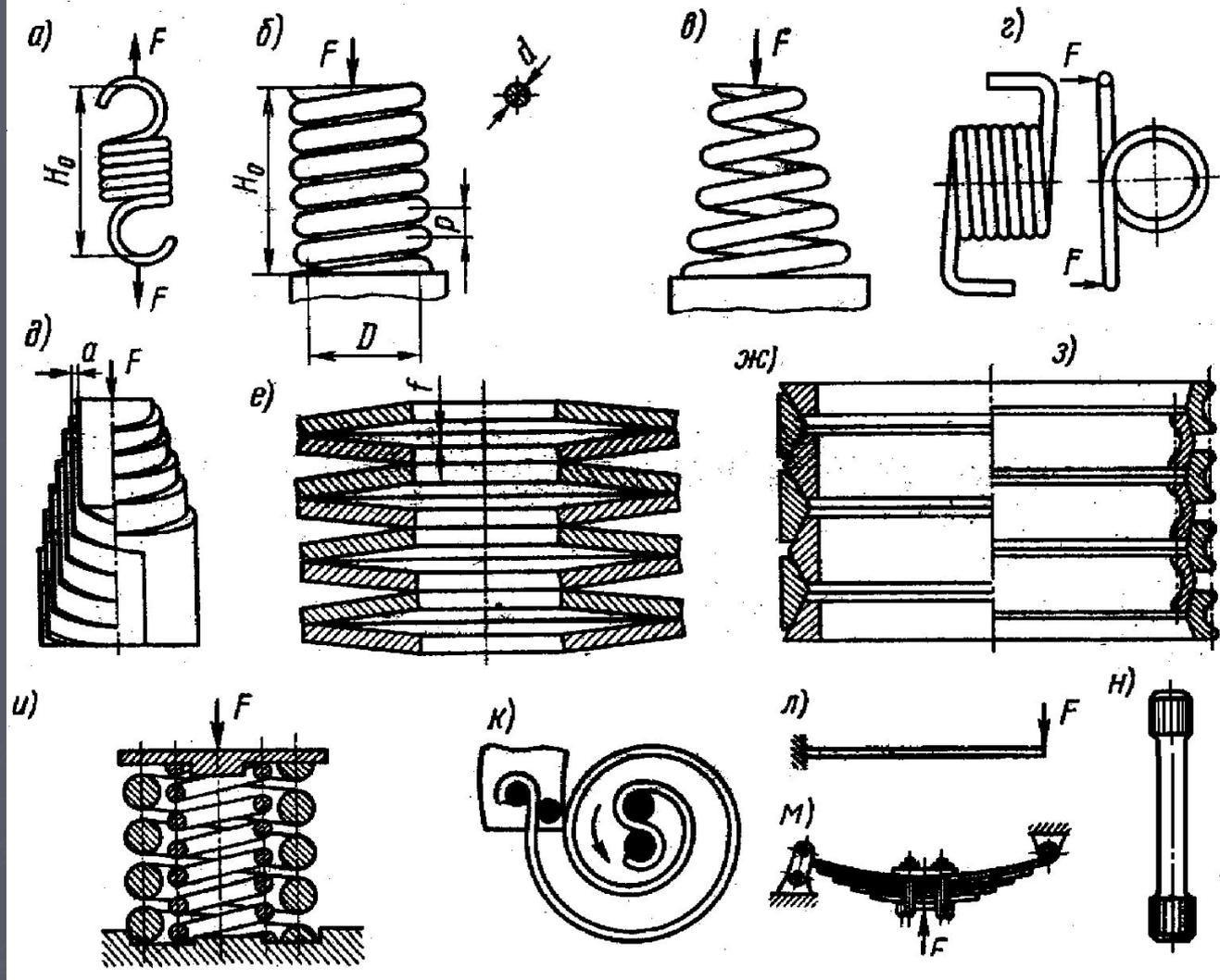
**Рис. 17.1. Некоторые упругие элементы машин:** винтовые пружины - а) растяжения, б) сжатия, в) коническая сжатия, г) кручения; д) телескопическая ленточная сжатия; е) наборная тарельчатая; ж, з) кольцевые; и) составная сжатия; к) спиральная; л) изгиба; м) рессора (наборная изгиба); н) торсионный валик.
