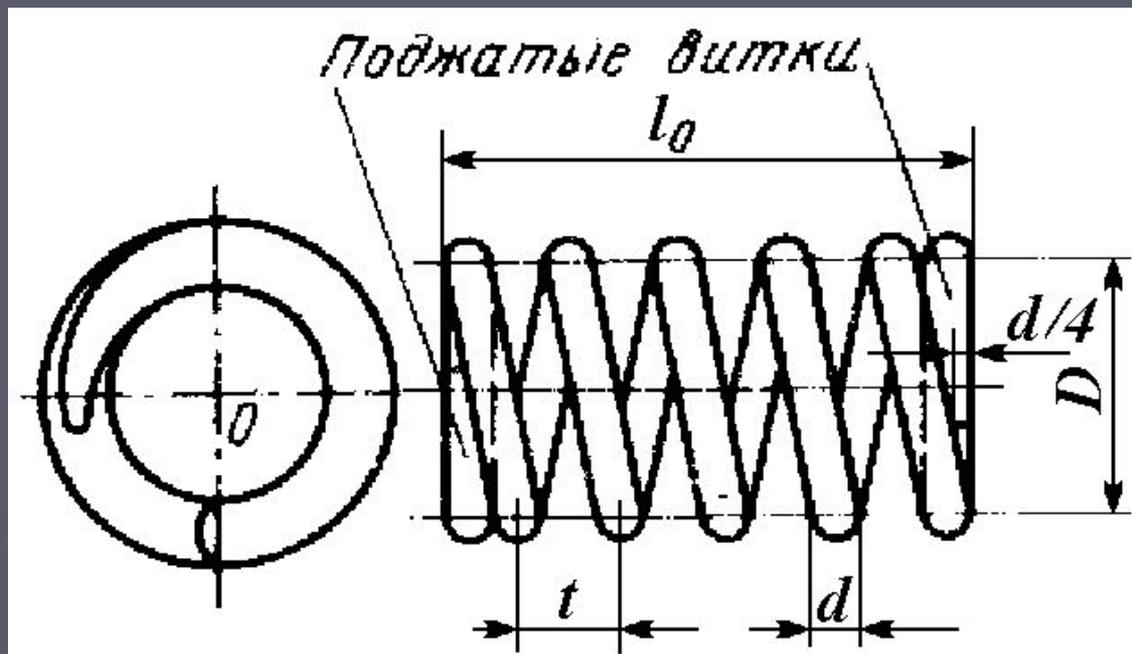
**Рис. 17.2. Цилиндрическая пружина сжатия**
