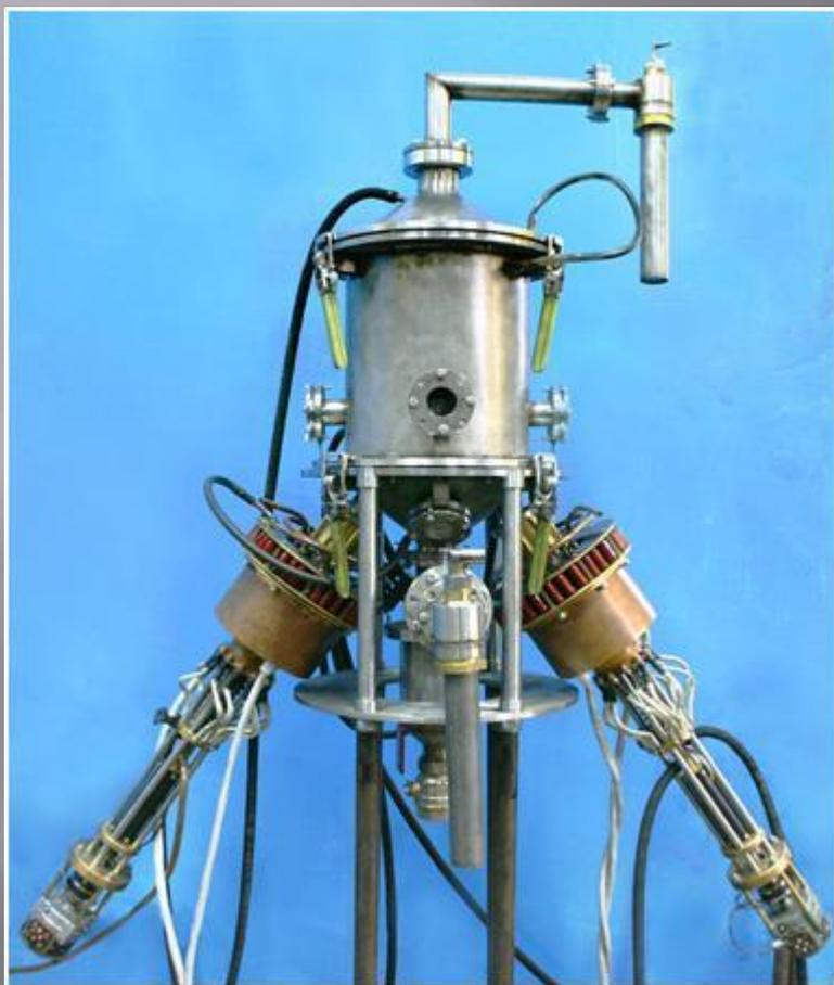
Высокопроизводительная установка для синтеза нанодисперсных веществ на основе углерода
