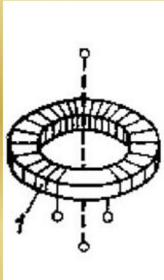
Одновитковые трансформаторы тока имеют две разновидности: без собственной первичной обмотки; с собственной первичной обмоткой. Одновитковые ТТ, не имеющие собственной первичной обмотки, выполняются встроенными, шинными или разъемными.
