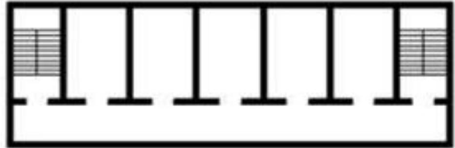
Рисунок – Ячейковая планировочная схема
