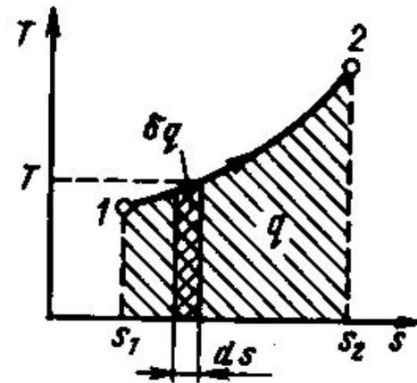
Рис. 3.1. Графическое изображение теплоты в  $T, s$ -координатах
