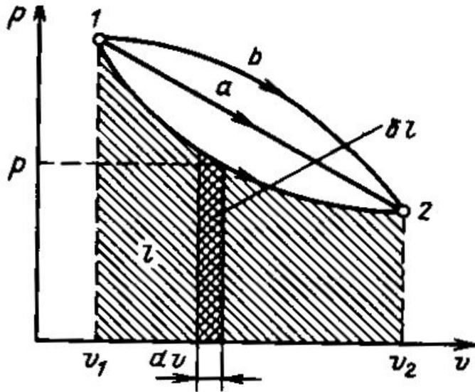
Рис. 2.2. Графическое изображение работы в  $p, v$ -координатах
