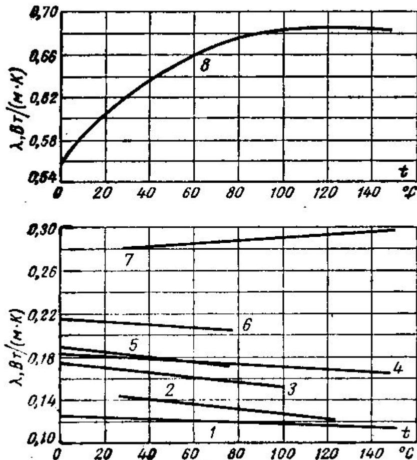
Рис. 1.7. Коэффициенты теплопроводности различных жидкостей.
