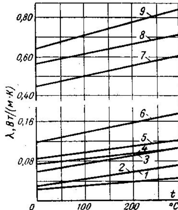
Рис. 1.10. Коэффициенты теплопроводности строительных и теплоизоляционных материалов.
