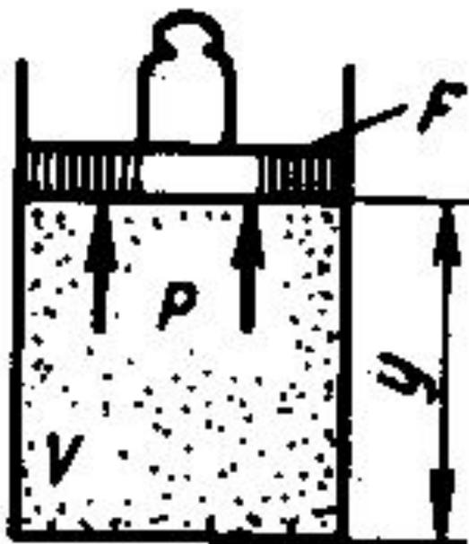
Физический смысл энтальпии выясним на следующем примере. Рассмотрим расширенную систему, включающую газ в цилиндре и поршень с грузом общим весом  $G$  (рис. 2.4). Энергия этой системы складывается из внутренней энергии газа и потенциальной энергии поршня с грузом в поле внешних сил:  $E = U + Gy$ . В условиях равновесия ( $G = pF$ ) эту функцию можно выразить через параметры газа:  $E = U + pFy = U + pV$ .
