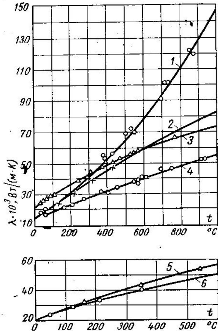
Рис. 1.5. Коэффициенты теплопроводности газов.
