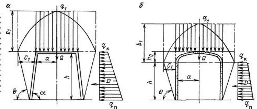
с. 17.4. Схемы к расчету нагрузки на крепь при неустойчивых кровле и бо-
