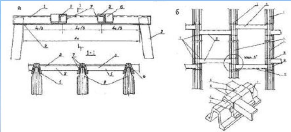
а) трапециевидная рамная смешанная крепь с верхняком из шахтного профиля СВП и межрамными соединениями: 1- верхняк; 2- стойки крепи; 3- межрамные соединения; 4- ограничитель смещения стоек; 5- элемент межрамного соединения; 6- соединительный элемент межрамного соединения; 7- бобышка фиксации положения межрамного соединения.
