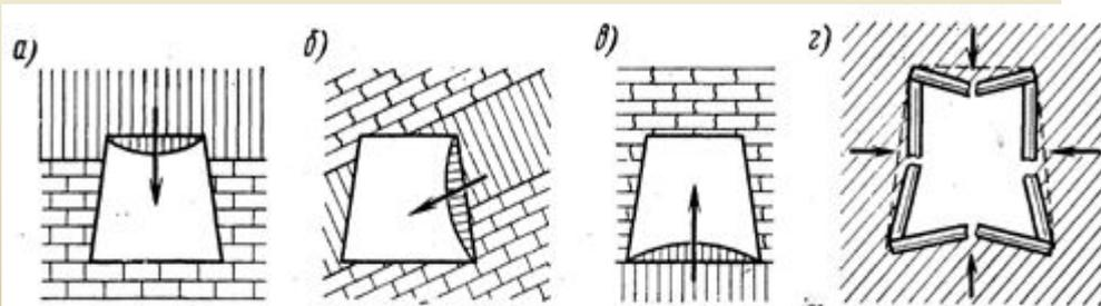
Рис. 9. Действие горного давления на крепь штольнеобразной выработки:
