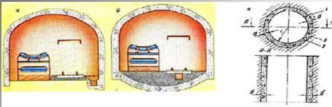
Бетонная крепь с вертикальными стенами и сводчатым перекрытием (а), с обратным сводом (б), (в) монолитная крепь вертикального ствола.
