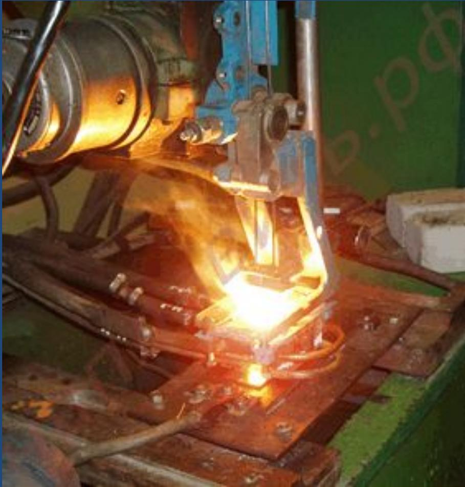
При электрошлаковой наплавке для оплавления основного и присадочного металла служит шлаковая ванна, разогреваемая проходящим через нее электрическим током. Этот способ наплавки, как правило, сочетается с принудительным формированием наплавляемого слоя.
