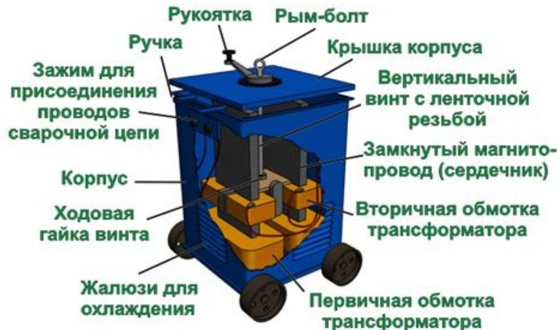
Трансформаторы с подвижными обмотками (к ним относятся сварочные трансформаторы типа ТС, ТСК и ТД) получили в настоящее время широкое применение при ручной дуговой сварке. Они имеют повышенную индуктивность рассеяния и выполняются однофазными, стержневого типа, в однокорпусном исполнении.
