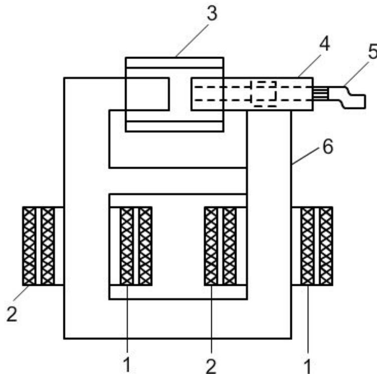
Однокорпусные трансформаторы более компактны, масса их меньше, чем у трансформаторов с отдельным дросселем. Мощность при этом примерно одинакова. Трансформаторы типа ТСД применяются для автоматической и полуавтоматической сварки
