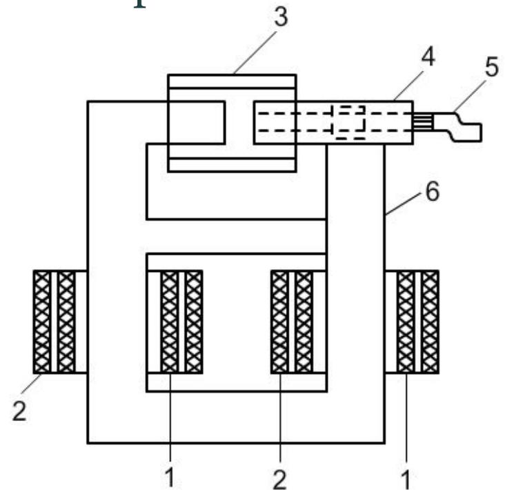
К данному типу сварочных трансформаторов относятся трансформаторы с подвижными обмотками и трансформаторы с магнитными шунтами.
