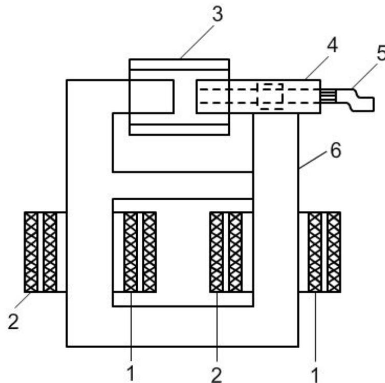
В некоторых конструкциях подвижный пакет передвигается не в ручную, а с помощью специального электродвигателя.
