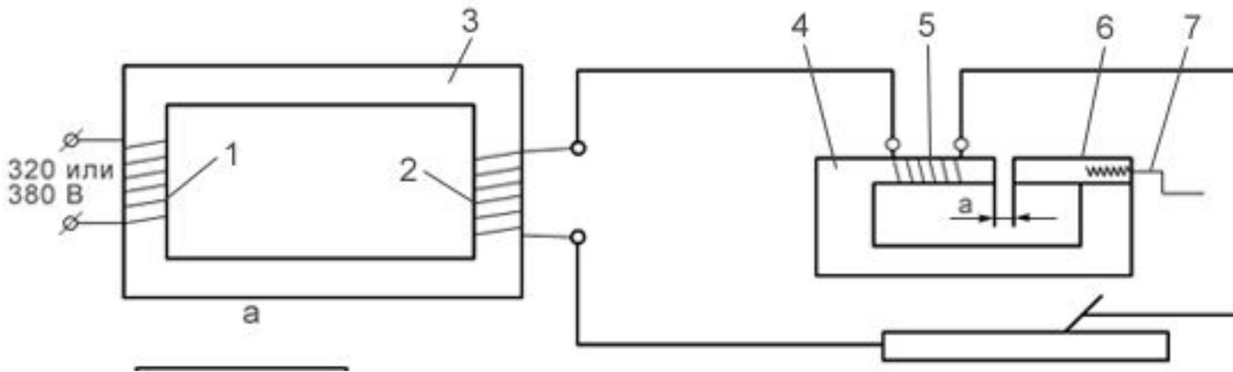
Понижающий трансформатор состоит из двух обмоток: первичной 1 и вторичной (понижающей) 2, расположенных на магнитопроводе 3.
