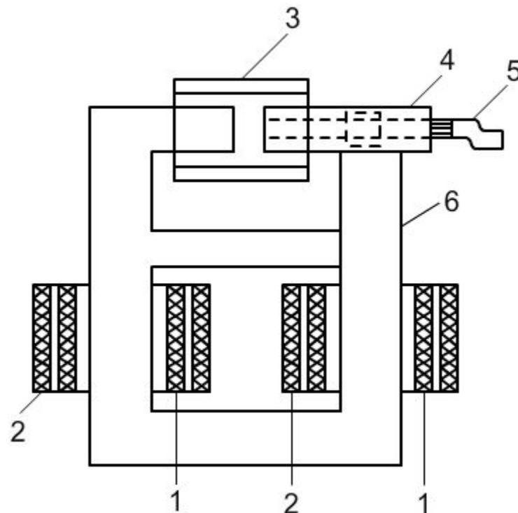
Принцип действия регулятора (дресселя) в данном случае - с помощью изменения воздушного зазора. Магнитопровод сварочного трансформатора состоит из двух сердечников – трансформатора и дресселя, которые связаны между собой.
