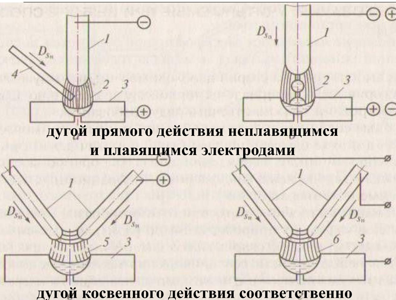
дугой прямого действия неплавящимся и плавящимся электродами
