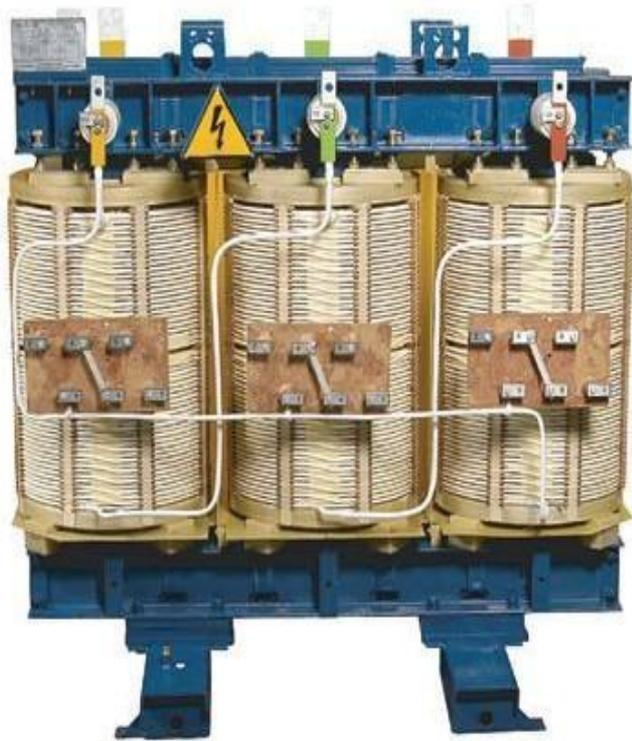
Силовые трехфазные трансформаторы с защитным кожухом предназначены для преобразования электроэнергии в сетях энергосистем. Чаще всего используются в больницах, метрополитене, жилых комплексах, производственных объектах. Сухие трансформаторы имеют высокую надежность, практически не требуют затрат на обслуживание, экономичны, просты в эксплуатации, уровень шума минимален.
