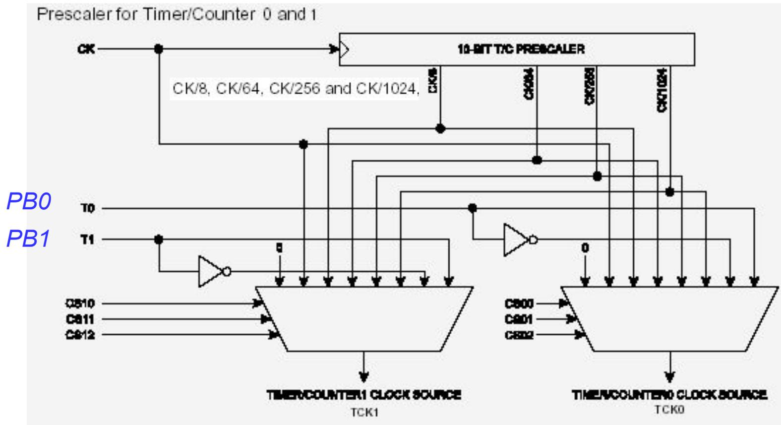
**Предварительное деление частоты для тактирования таймеров TM0, TM1 МК**
