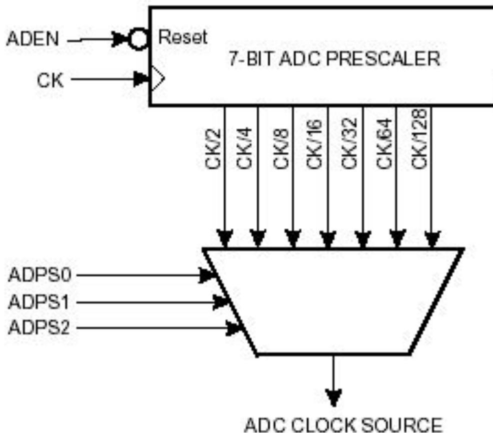
**Предварительное деление частоты XTAL для тактирования АЦП МК**
