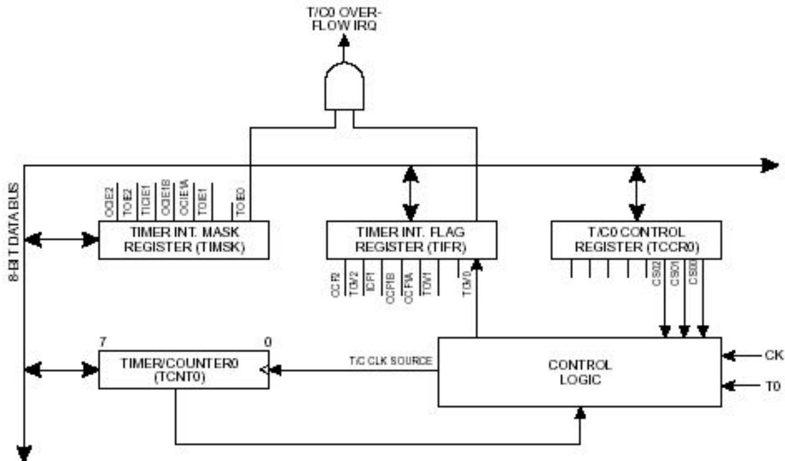
Структура таймера ТМ0 МК
