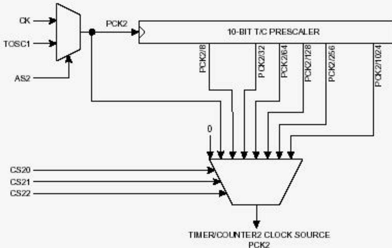
**Предварительное деление частоты для тактирования таймера ТМ2 МК**
