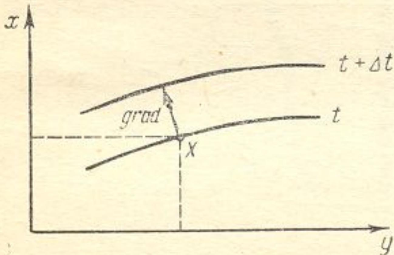
Рис. 1.2. Изолинии температур двумерного поля:
