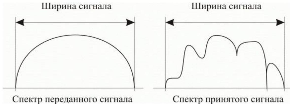
Рис. 2. Искажение сигнала за счёт присутствия многолучевой интерференции
