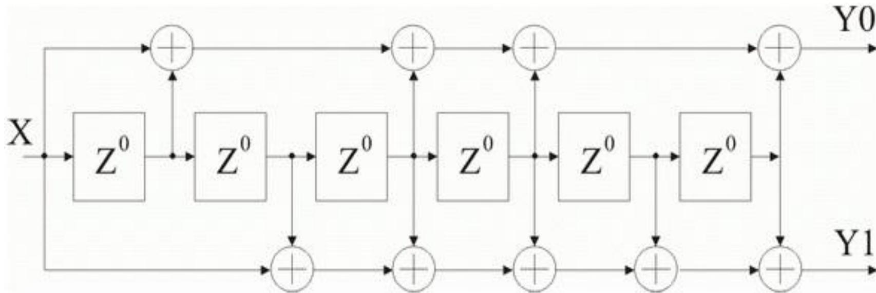
Рис. 10. Схема свёрточного кодера ( $K = 7$ ); скорость кодирования  $1/2$
