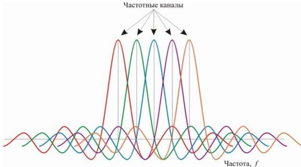
Рис. 6. Частотное разделение каналов с ортогональными несущими сигналами
