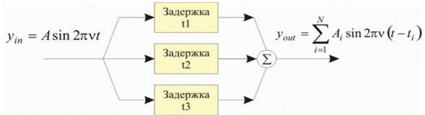
Рис. 1. Модель многолучевого распространения сигнала
