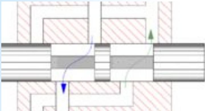
Пояски золотника при наличии конусности; при такой конструкции "трогание с места" и оствовка выходного звена гидросилителя происходит более плавно
