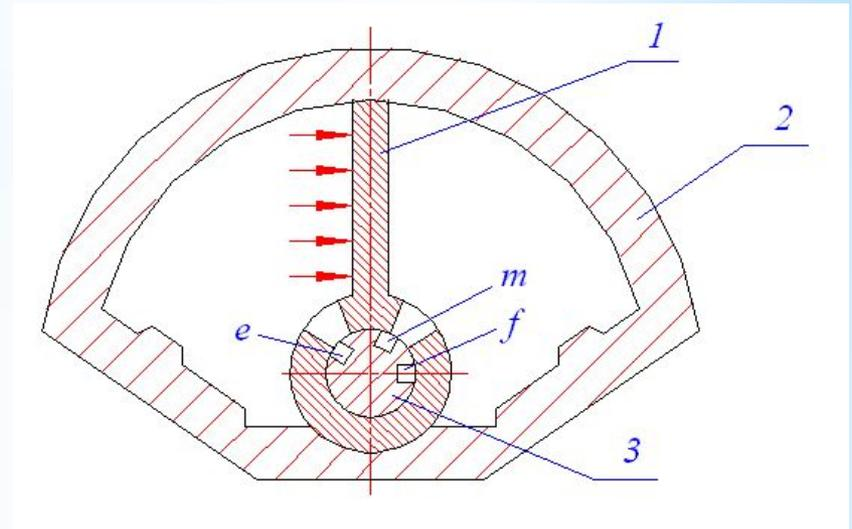
Конструктивная схема гидроусилителя крутящего момента, выполненного на базе поворотного гидродвигателя: жидкость подаётся по каналам *e* и *f*, а сливается по каналу *m*
