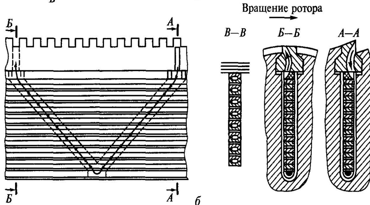
Рис. 2.6. Схема охлаждения роторов турбогенераторов серий ТВФ и ТВВ:
