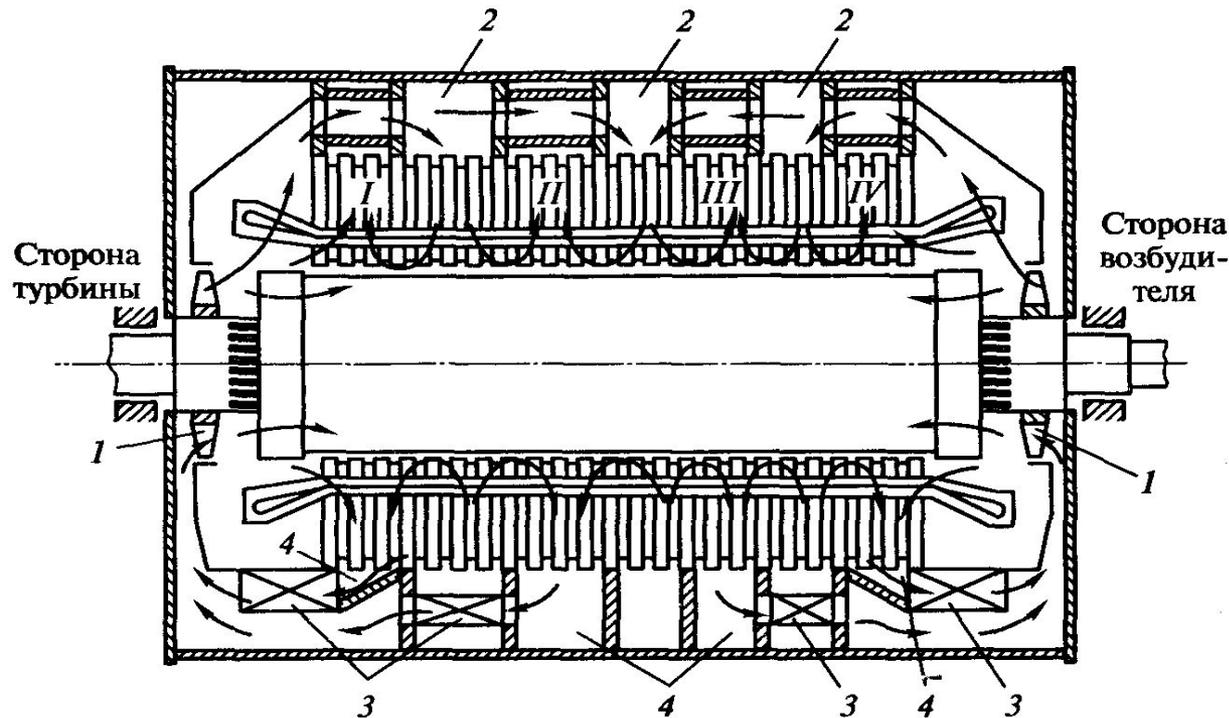
Рис. 2.4. Многоструйная система водородного охлаждения турбогенератора:
