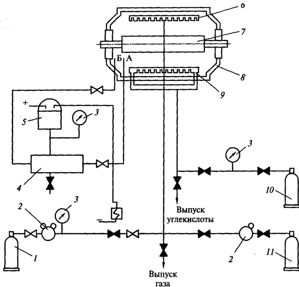
Рис. 2.5. Принципиальная схема газового хозяйства системы водородного охлаждения:
