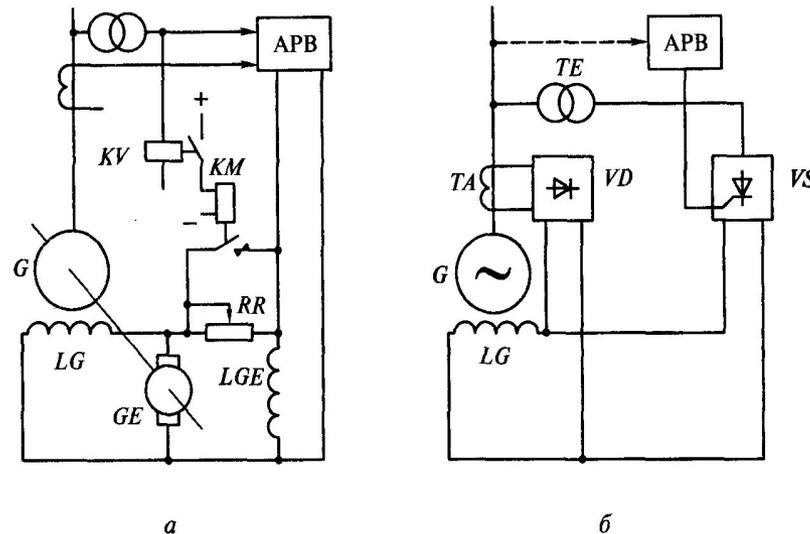
Рис. 2.9. Принципиальные схемы возбуждения генераторов:
