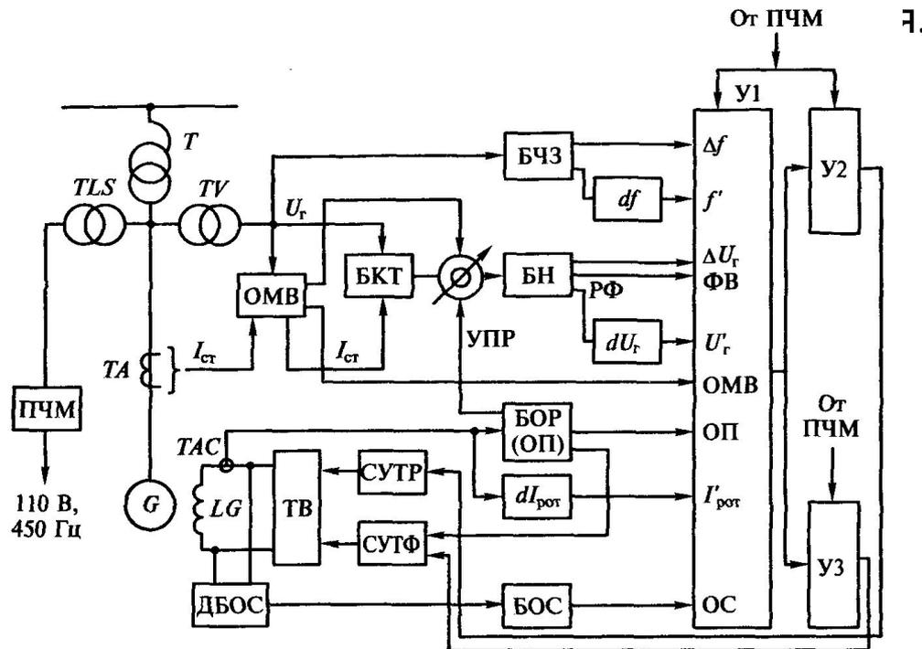
Рис. 2.13. Структурная схема АРВ сильного действия
