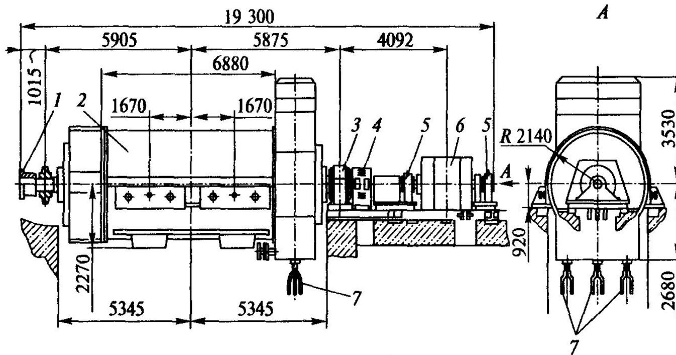
Рис. 2.8. Турбогенератор ТЗВ-800-2УЗ и возбудитель ВТ-6000-2УЗ:
