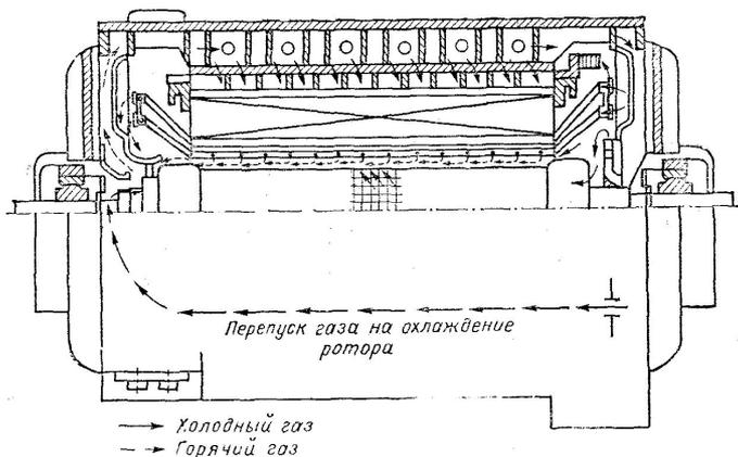
Обмотки статора турбогенераторов охлаждаются по различным схемам. У ТГВ-200 полые проводники со стороны лобовых частей, а со стороны паза — гофрированные трубки. У ТГВ-300 лобовые и пазовые части проводников охлаждаются с помощью водорода.
