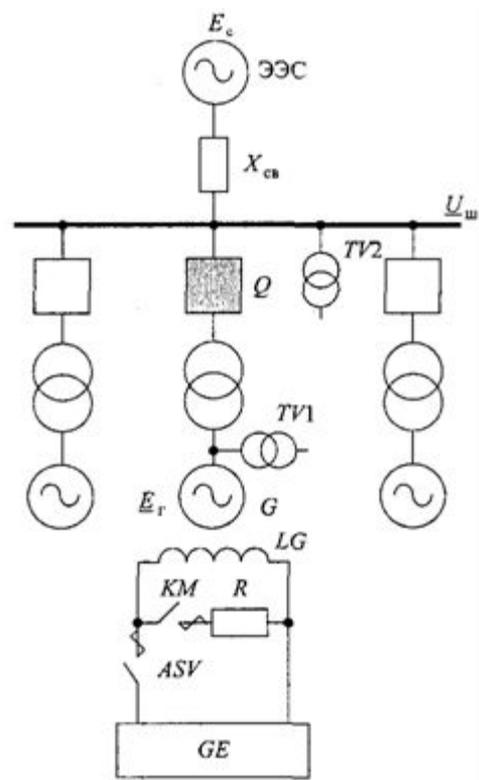
При включении генератора на параллельную работу методом **самосинхронизации** его число оборотов подгоняется вручную и при скорости, близкой к синхронной, не возбужденный генератор включается в сеть, затем генератор возбуждается и втягивается в синхронизм.
