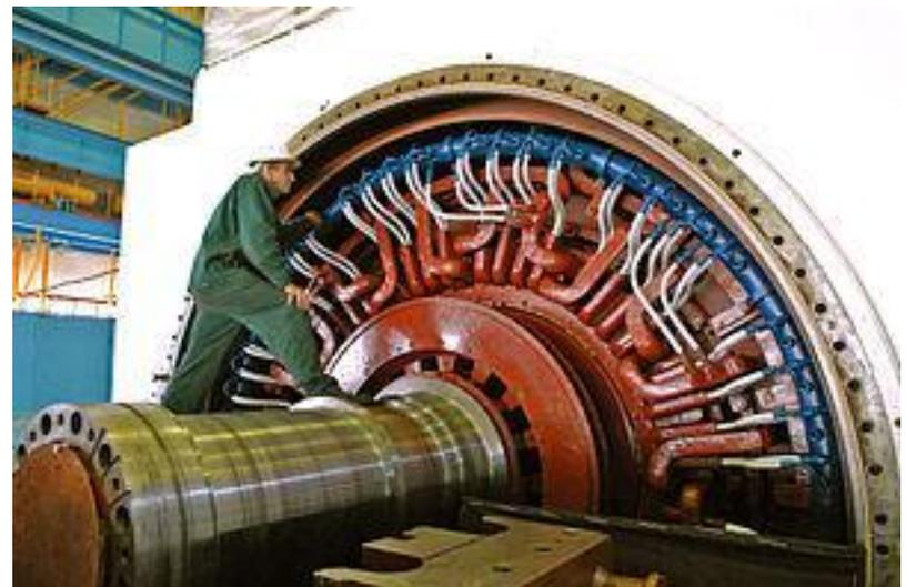
Гидравлические турбины обычно развивают небольшую частоту вращения (50 – 500, иногда 1000 об/мин), которая тем меньше, чем меньше напор воды и чем больше мощность турбины. Гидрогенераторы поэтому являются тихоходными машинами и имеют большие размеры и массы, а также большое число полюсов, для получения частоты 50 Гц.
