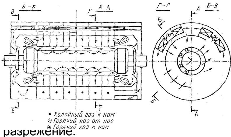
ся вентиляторами, установленными по торцам гели в радиальные каналы сердечника статора, каналы, образованные вырезами в проводниках обмотки ротора к дну паза и обратно. Входные и выходные каналы снабжены дефлекторами такого профиля, при котором водород создает напор, а на выходе — разрежение.
