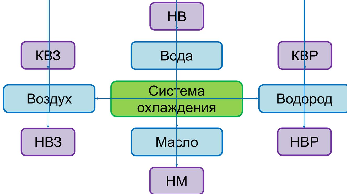
Турбогенераторы выполняются с воздушным, водородным, водородно-жидкостным или чисто жидкостным охлаждением. Гидрогенераторы имеют воздушное или воздушно-жидкостное охлаждение.
