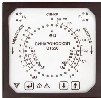
Точное соблюдение условий синхронизации замедляет процесс синхронизации. Также трудно достигнуть условия, чтобы частота генератора и сети уравнилась именно в тот момент, когда напряжения совпадают по фазе (стрелка синхроскопа остановится точно на вертикальной черте), тогда приходится преднамеренно нарушать равенство частот, чтобы заставить стрелку вновь вращаться.
