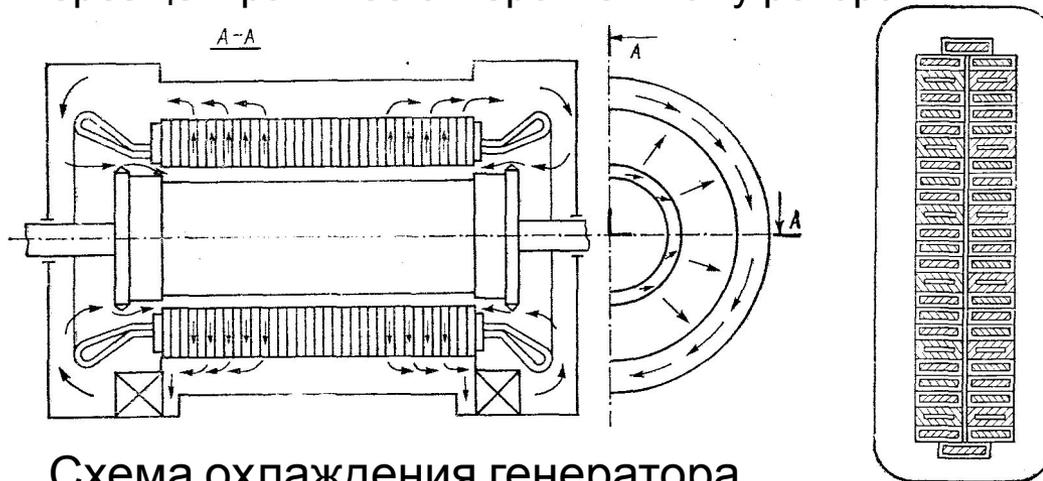
Схема охлаждения генератора
