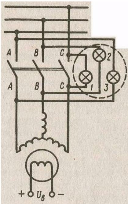
*Ламповый синхроскоп* состоит из трех ламп, включенных «на погасание» или «на вращение света». При включении ламп «на погасание» момент синхронизации наступает при одновременном погасании всех ламп.
