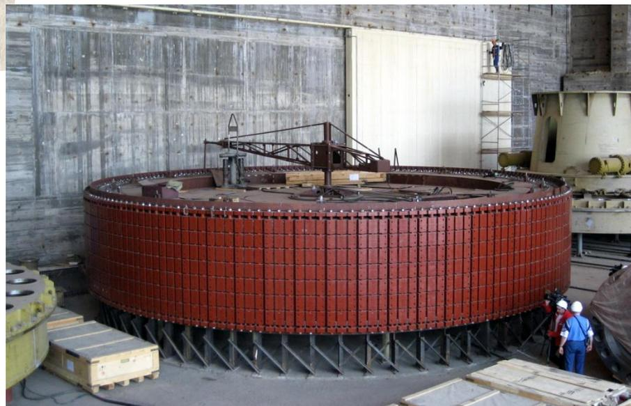
Т.к. частота вращения мала, а число пар полюсов велико, ротор генератора выполняется с большим диаметром и сравнительно малой активной длины. Диаметры роторов достигают 14 – 16 м, а диаметры статоров – 20 – 22 м. Поэтому статор гидрогенераторов выполняется разъемным. Он делится по окружности на две – шесть равных частей, что значительно облегчает его транспортировку и монтаж.
