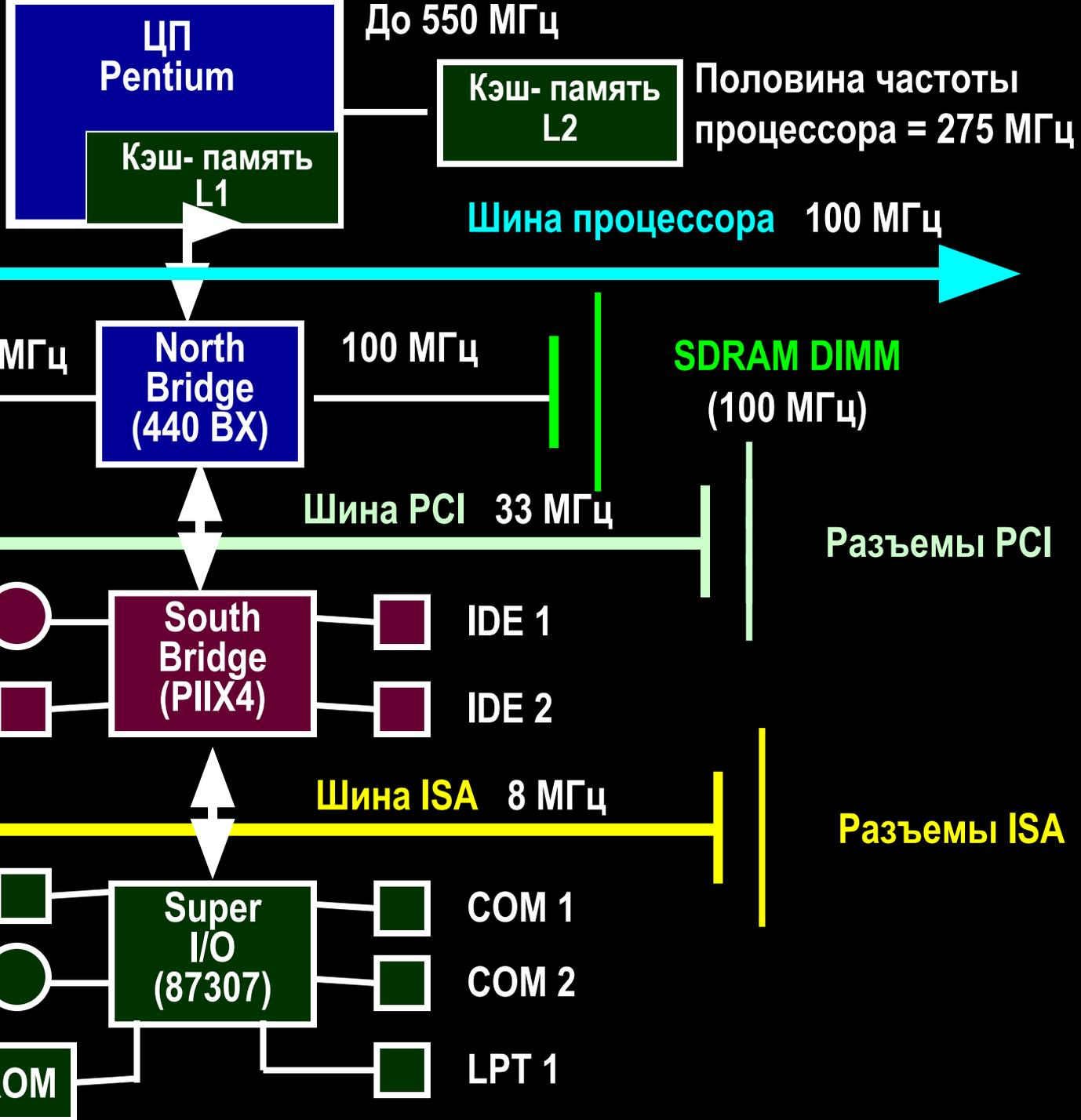
Шина процессора работает намного быстрее любой другой шины. Сигнальные линии шины предназначены для передачи данных, адресов и сигналов управления между отдельными компонентами **PC**. Так, в **PC Pentium** шина состоит из **64** линий данных, **32** линий адреса и линий управления. Компьютеры **Pentium Pro** и **Pentium II** имеют по **36** линий адреса.
