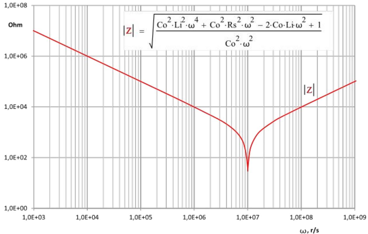
Выше определенной (резонансной) частоты емкость «теряет» свои параметры
