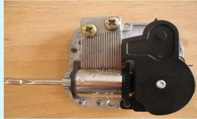
Инструмент, который издаёт звуки вследствие дрожания зубцов стальной гребёнки от соприкосновения с штифтиками вращающегося вала называется мелодион или музыкальный ящик, иначе музыкальная табакерка, который был изобретён Дитцем. Приводить в движение такие механизмы приходилось вручную - простые варианты требовали постоянного вращения специальной ручки, а более дорогие музыкальные шкатулки имели заводной механизм, как на механических будильниках.
