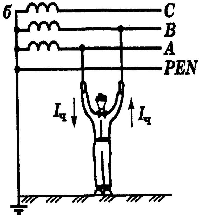
Однофазное прикосновение в сети с заземленной нейтралью
