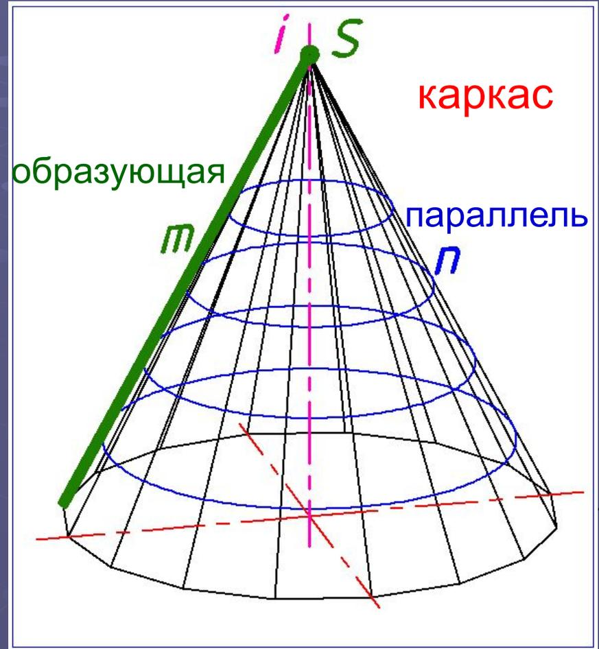
Каркас конуса состоит из образующих (отрезков) и параллелей (окружностей)
