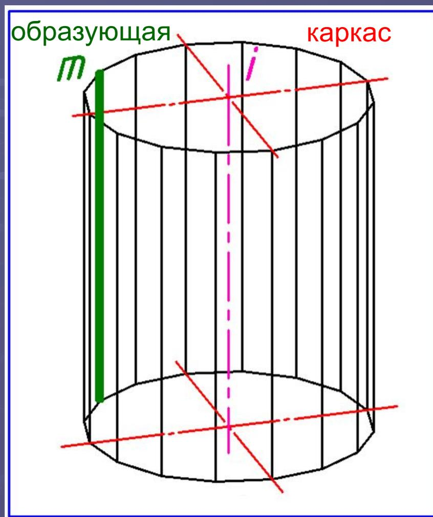
Каркас цилиндра состоит из образующих (отрезков) параллельных оси
