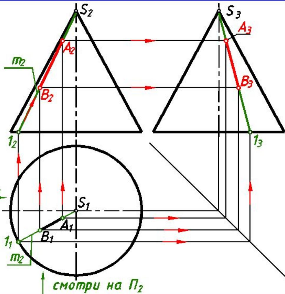
Проекции точек, заданных на поверхности конуса, находим по принадлежности **образующим** или **параллелям** (окружностям). Точки **A** и **B** принадлежат образующей  $m(S_1)$ .
