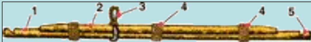
На рисунке: 1 — реек; 2— шкала; 3— третная стропка; 4 — полубензели; 5 — зарубка на ноке рейка.
