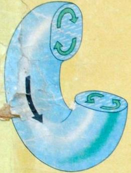
НАПРАВЛЕНИЕ ПОТОНА, ВЫХОДЯЩЕГО ИЗ НАСОСНОГО КОЛЕСА
