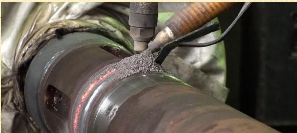
После разборки и дефектовки был произведен ремонт вала при помощи автоматической сваркой ,в слествии чего вал был обработан на точно - винторезном станке и шлифование дефектного участка вала .
