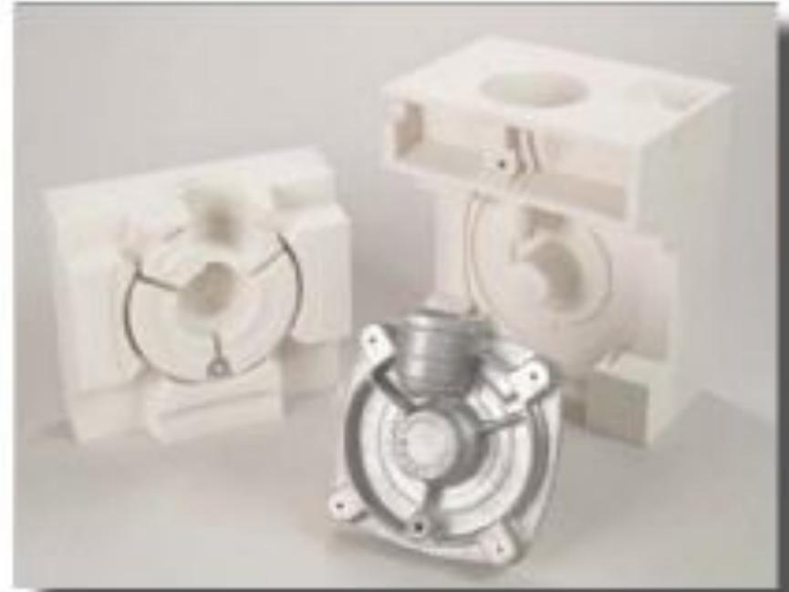
**Литейной формой называется комплекс элементов, образующих замкнутый объем, внутри которого расположена полость, повторяющая конфигурацию будущей отливки. Полость заполняется жидким металлом, который после затвердевания, выбивки и очистки становится отливкой.**
