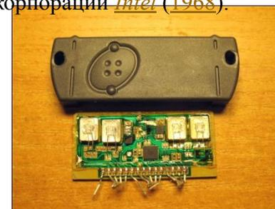
Гибридная микросборка STK403-090,
