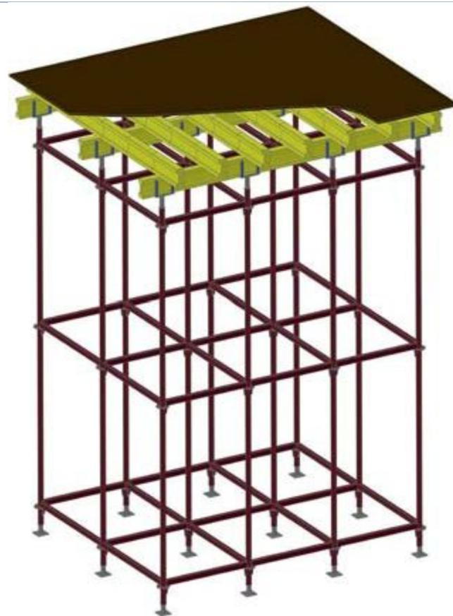
Универсальная система объемных стоек GW – модульная система разборно-переставной опалубки для возведения монолитных бетонных и железобетонных конструкций.
