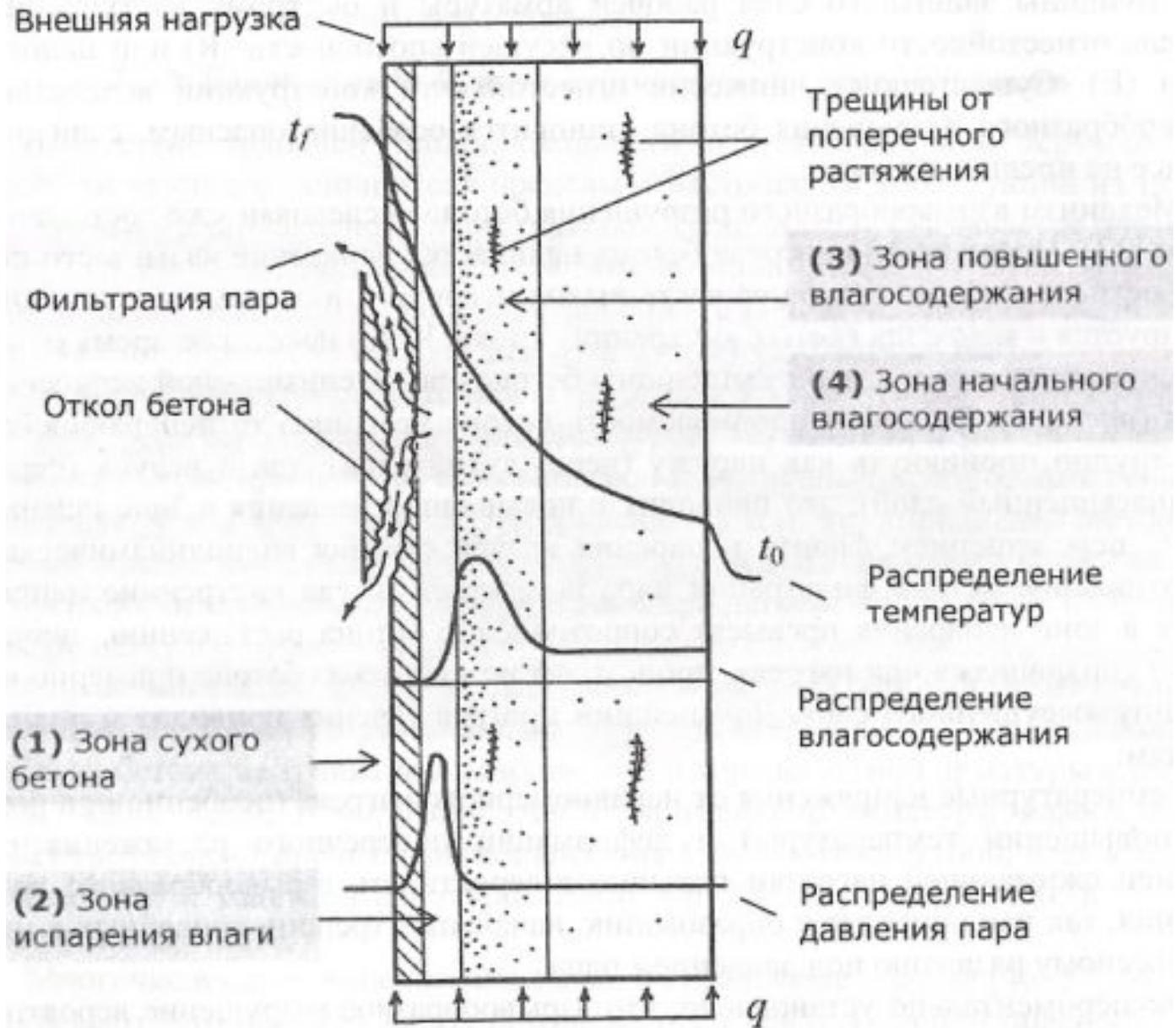
Схема 1 – Механизм «взрывообразного» разрушения
