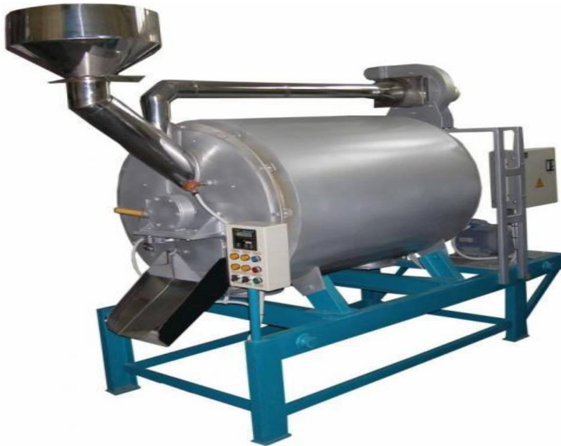
Принцип обжаривания печей контактно-конвективный, за счет разогретого барабана и продувки через продукт горячего воздуха. Данное сочетание методов обжарки позволяет получить высокие вкусовые качества семян, орехов.
