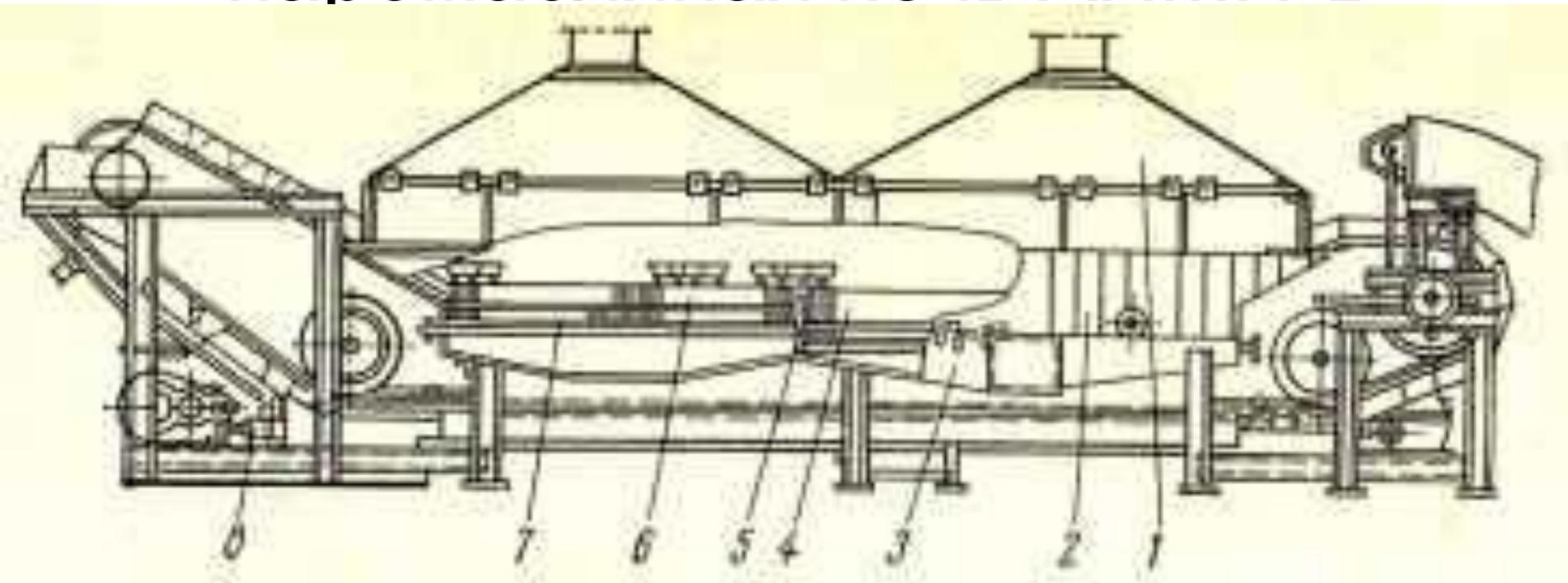
1 - вытяжной кожух; 2 - теплоизолирующая обшивка; 3 - ванна; 4 - трехрядная поверхность нагрева; 5 - перегородка; 6 - двухрядная поверхность нагрева; 7 - охладитель; 8 - привод.
