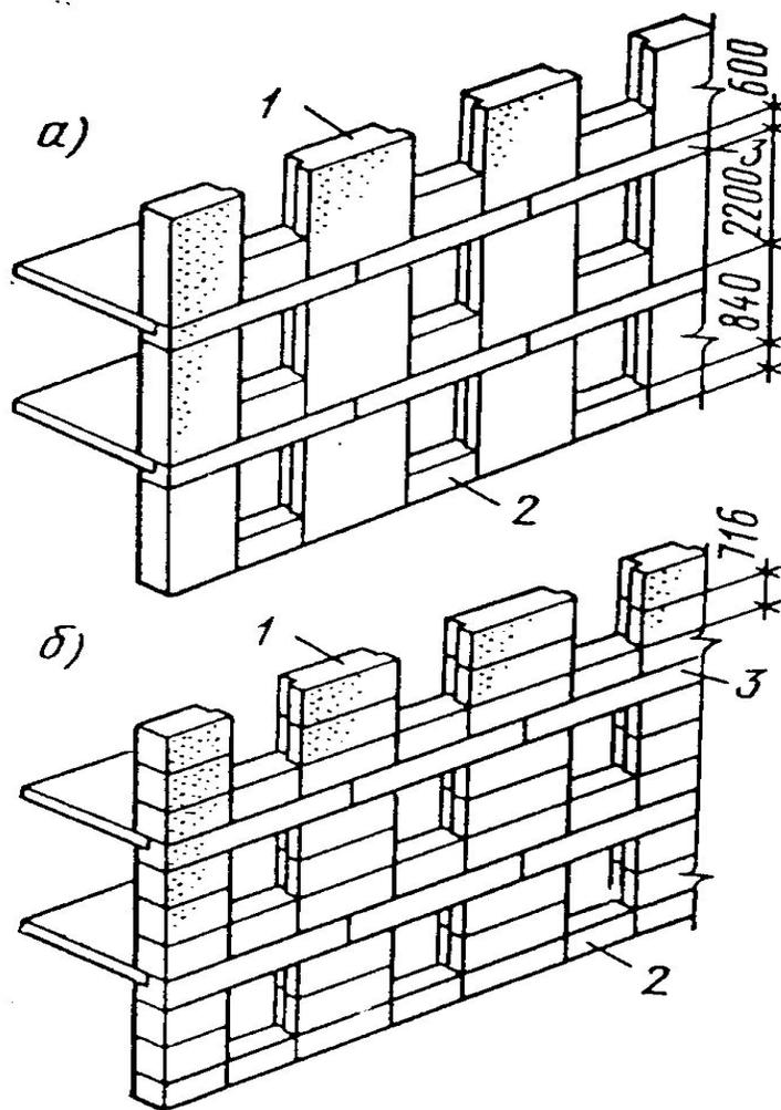
Схемы разрезки стен крупноблочных зданий:
