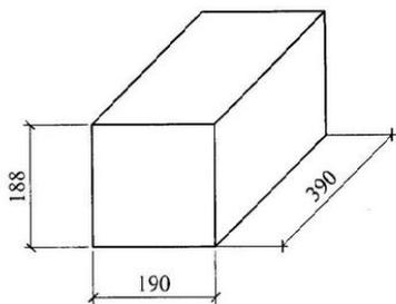
Размеры бетонных мелких блоков
