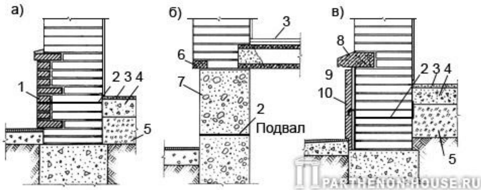
**Цоколи кирпичных стен:** а - облицованный отборным кирпичом; б - из бетонных блоков; в - облицованный тесаными плитами из натурального камня: 1 - лицевой **кирпич**; 2 - гидроизоляционный слой; 3 - пол первого этажа; 4 - бетонная подготовка; 5 - уплотненный грунт; 6 - кордон из железобетонных брусков; 7 - стена подвала из бетонных блоков; 8 - кордонный камень; 9 - осадочный зазор; 10 - каменные плиты
