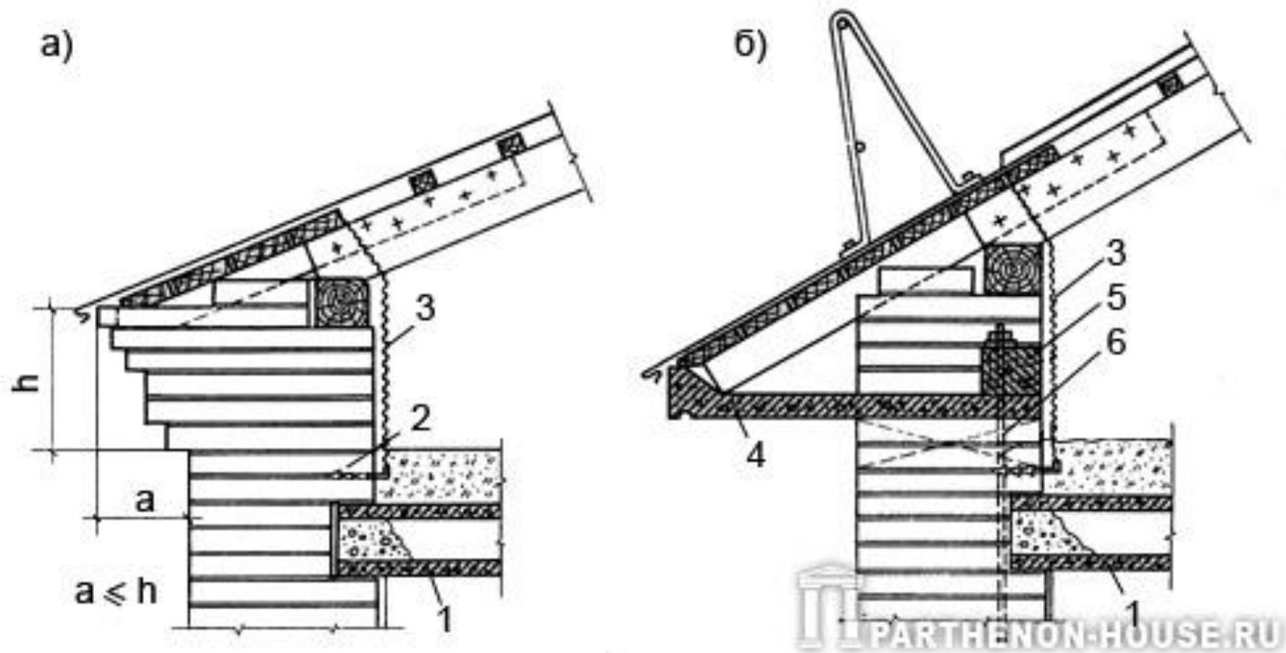
**Венчающие карнизы кирпичных стен:** а - кирпичный; б - из железобетонных плит; 1 - панель чердачного перекрытия; 2 - завершённый костыль; 3 - проволочная скрутка; 4 - железобетонная карнизная плита; 5 - анкерная железобетонная балка; б - анкер
