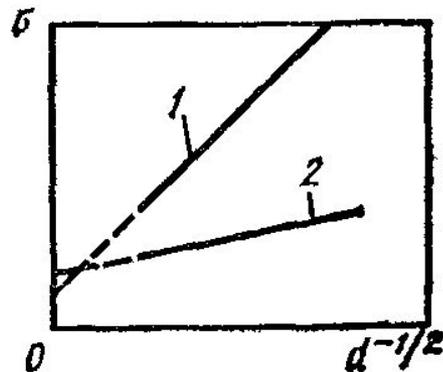
Зависимость прочностных свойств от размера зерна.
