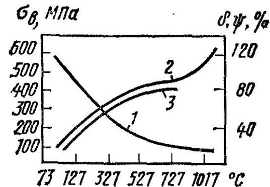
Зависимость механических свойств мелкозернистого бериллия от температуры.
