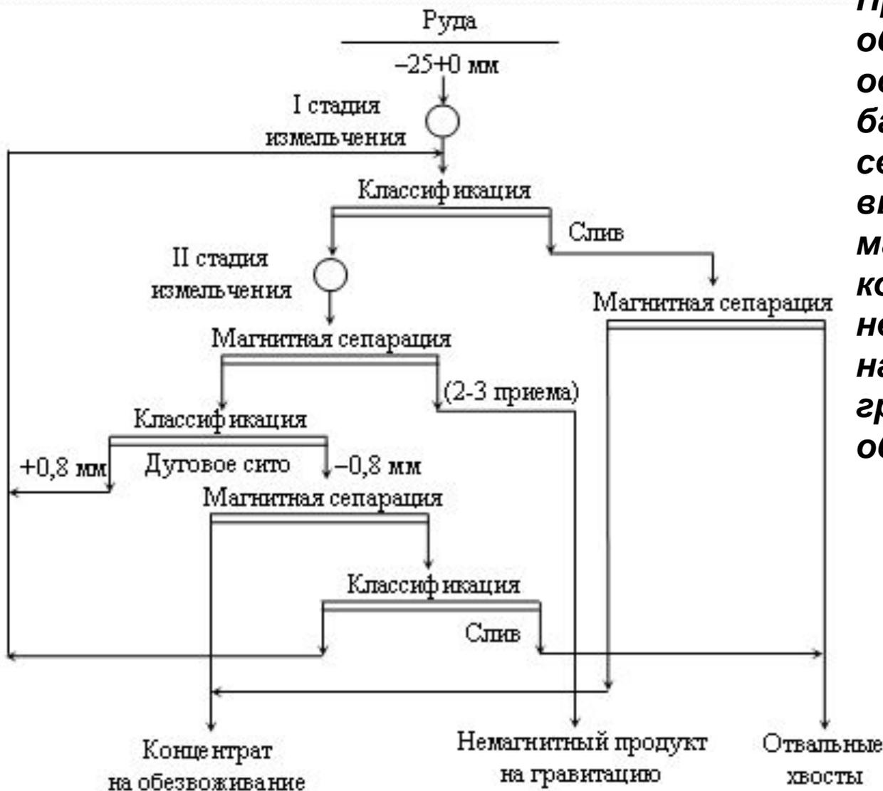
**Обогащение слабомагнитных руд** - применяют в сочетании с другими обогатительными процессами – гравитационным, электрическим обогащением, флотацией (например, при обогащении марганцевых руд и руд редких металлов) и лишь в ограниченных случаях в качестве основного процесса (для некоторых железных руд).
