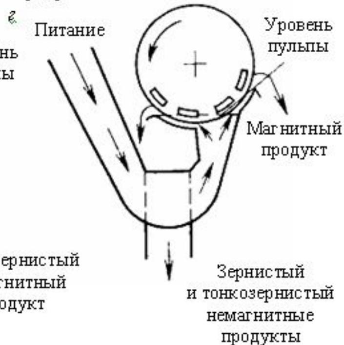
**Схемы магнитных барабанных сепараторов для мокрого обогащения со слабым полем с различными типами ванн.**
