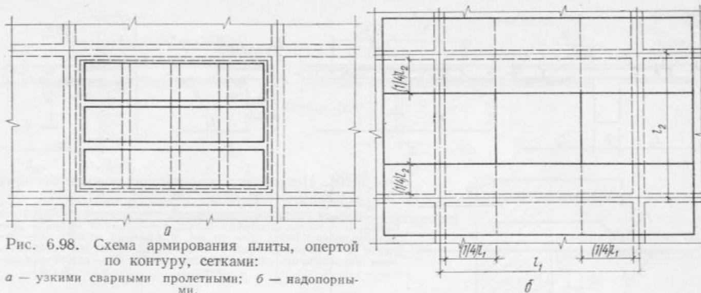
Рис. 6.98. Схема армирования плиты, опертой по контуру, сетками:
