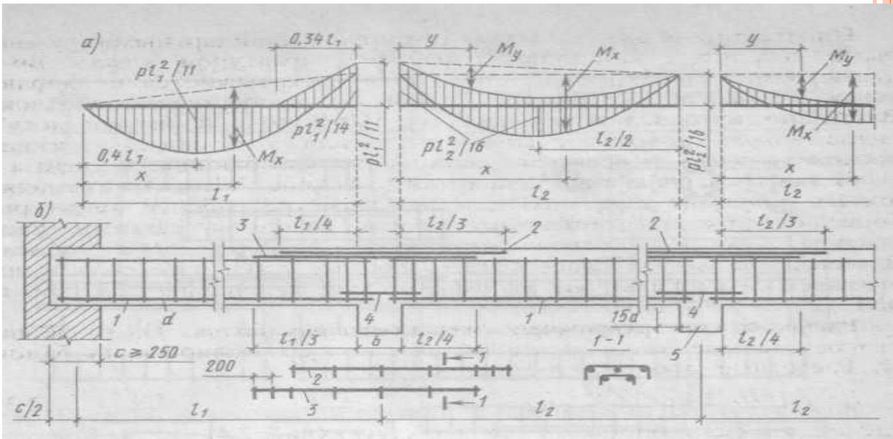
1 – пролетная арматура; 2, 3 – надпорная арматура; 4 – стыковой стержень диаметром  $d_1 \geq d/2$  и не менее 10 мм; 5 – главная балка
