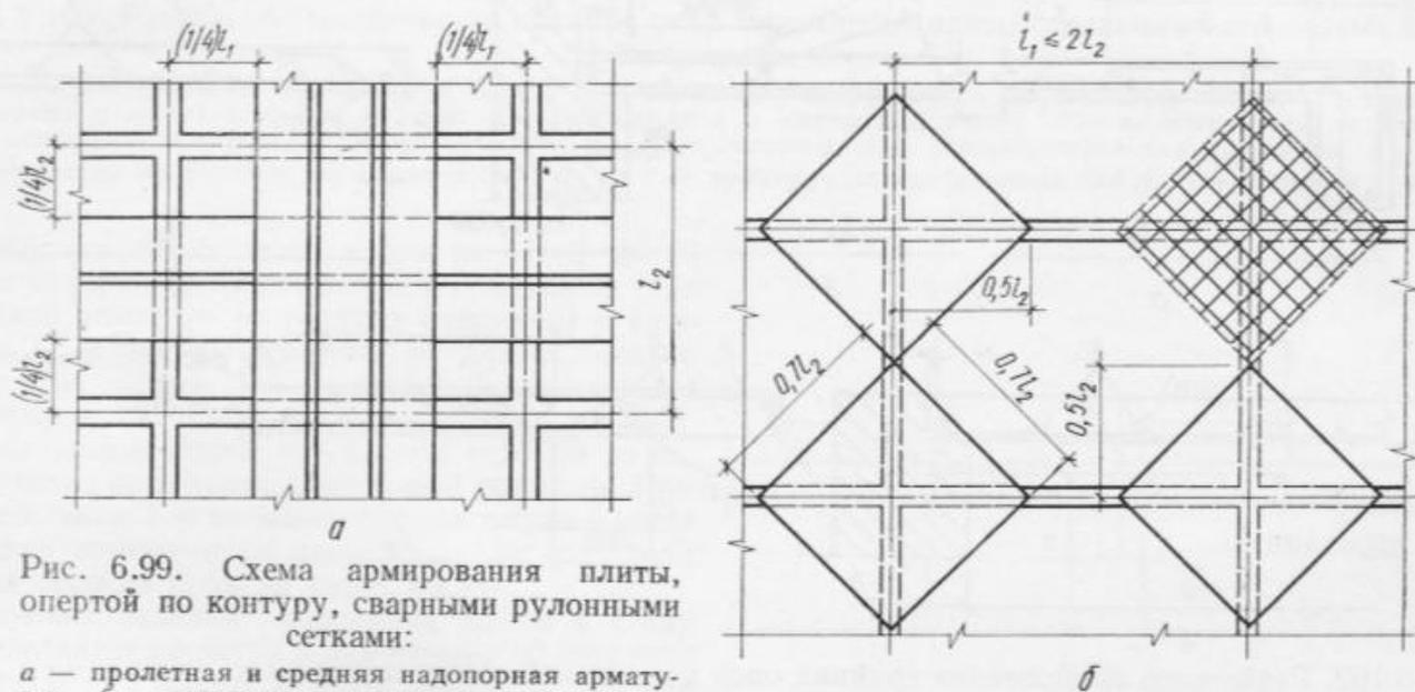
Рис. 6.99. Схема армирования плиты, опертой по контуру, сварными рулонными сетками:
