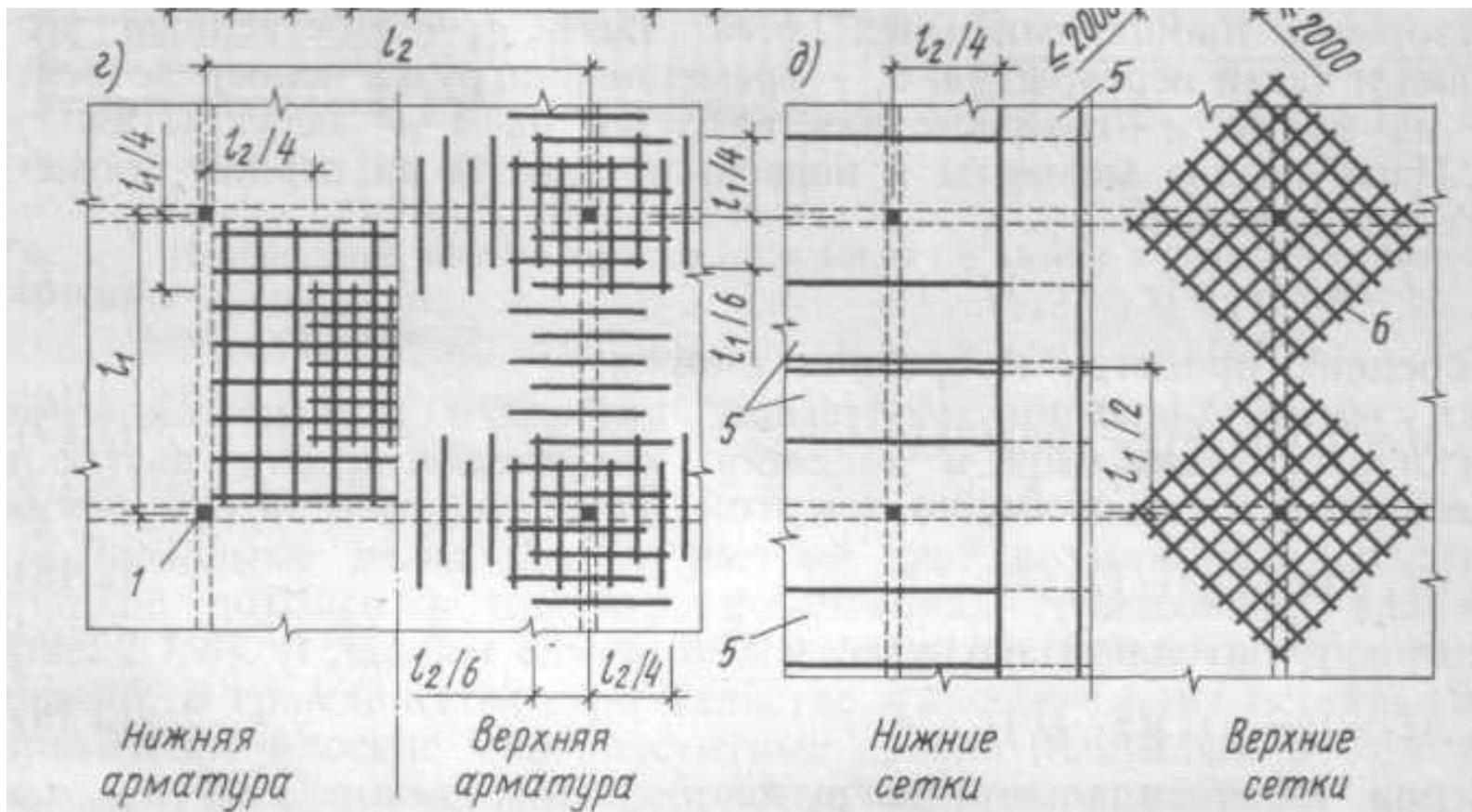
5 – пролетная рулонная сетка; 6 – надпорная сетка углов плиты
