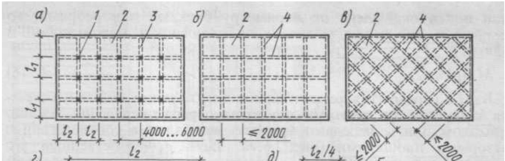
*a* – с балками, расположенными по осям колонн; *б, в* - кессонные
