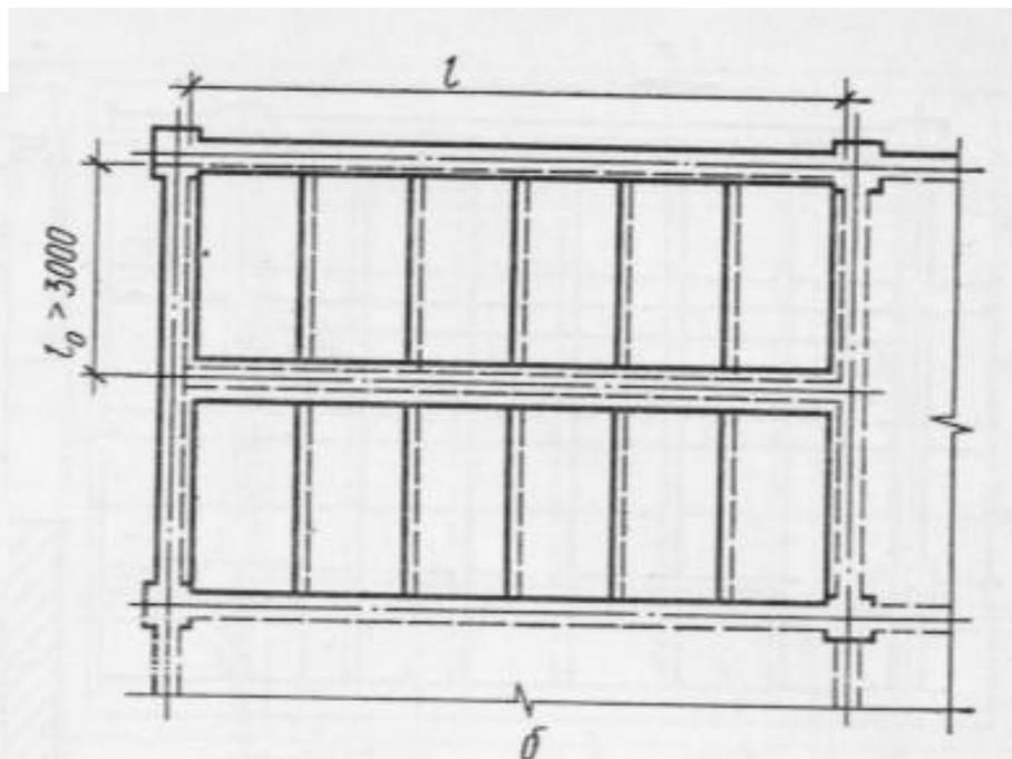
Рис. 6.94. Схема армирования монолитных балочных плит сварными сетками:
