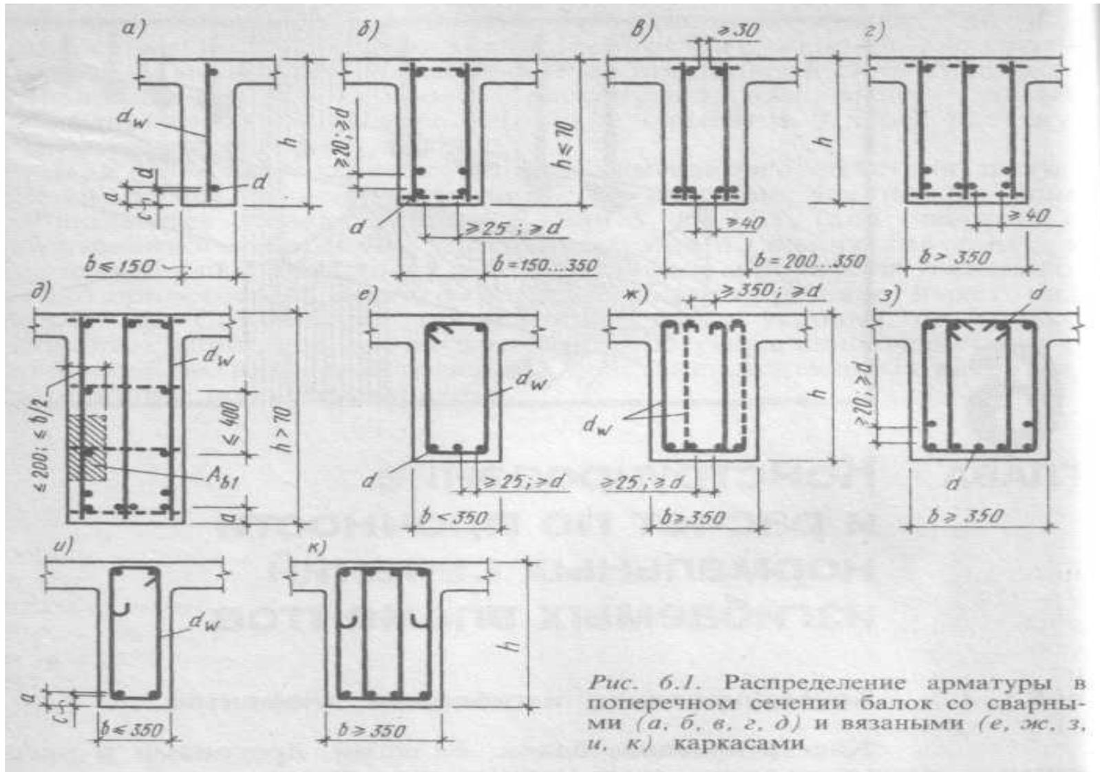
Рис. 6.1. Распределение арматуры в поперечном сечении балок со сварными (а, б, в, г, д) и вязаными (е, ж, з, и, к) каркасами
