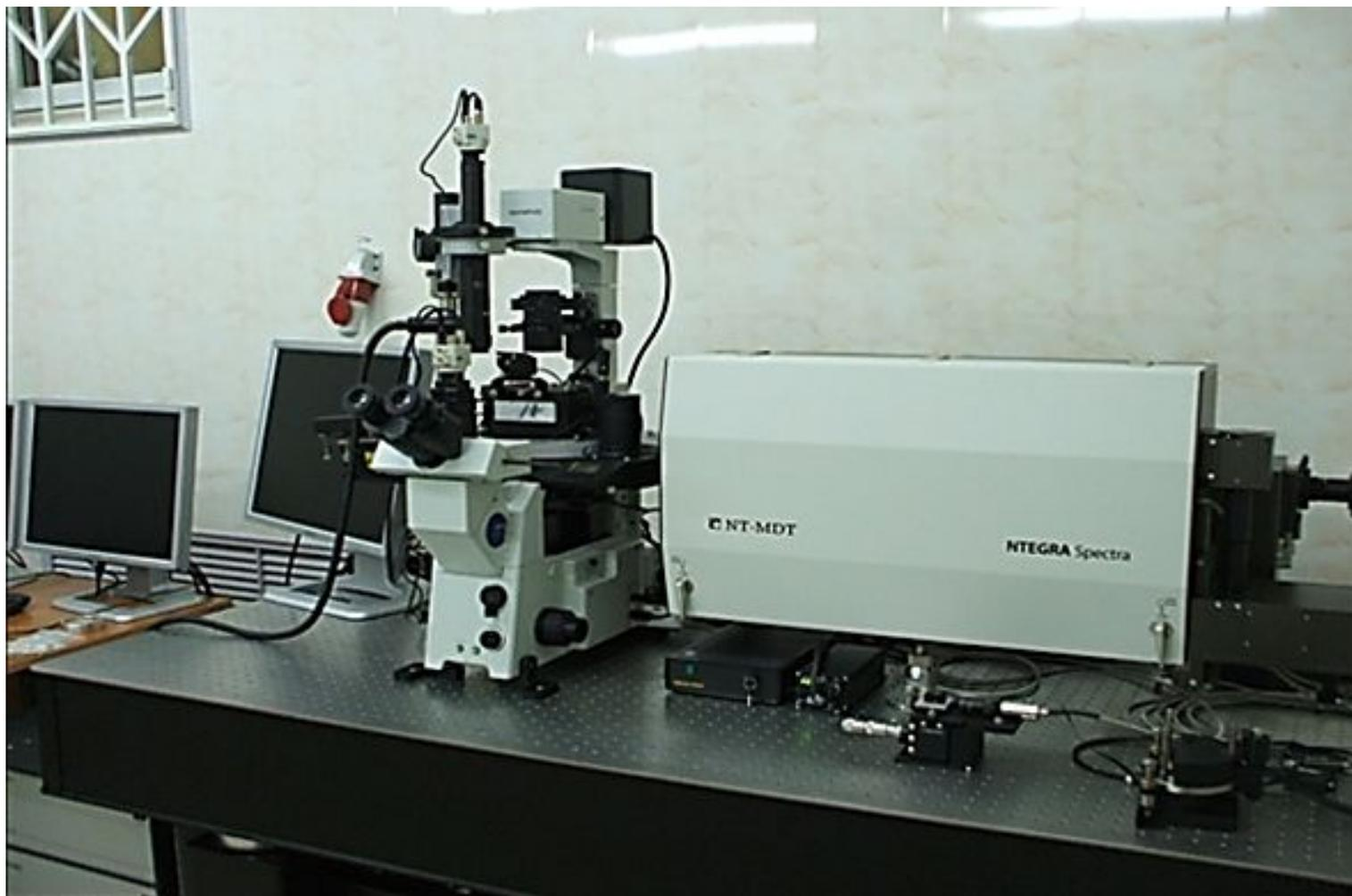
**Зондовый сканирующий микроскоп INTEGRA SPECTRA
