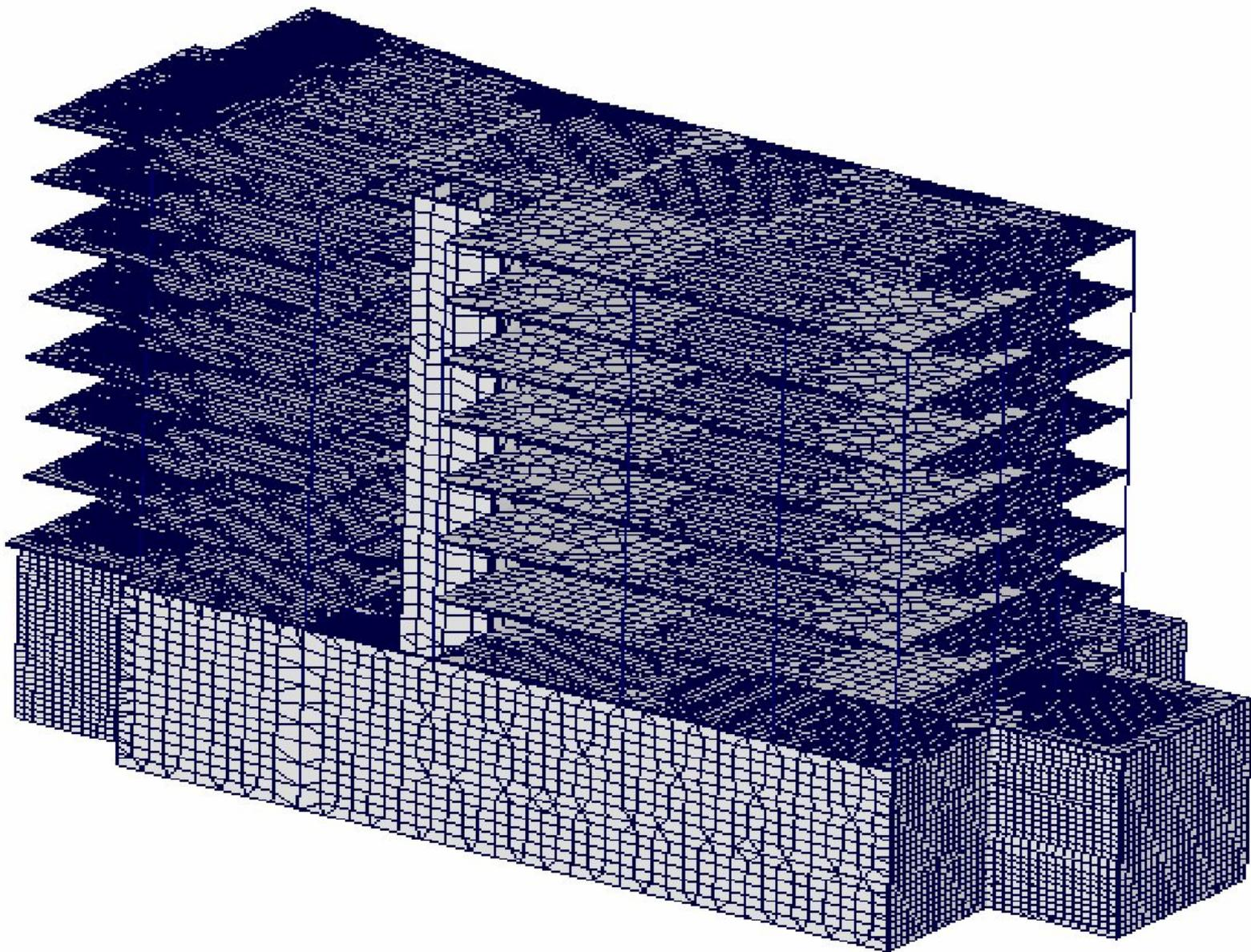
**Конечно-элементная схема взаимодействия несущей конструкции с основанием**
