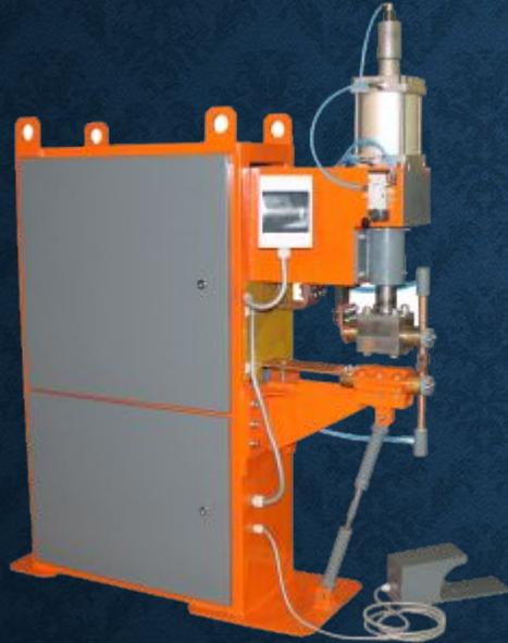
Машины серии МТР предназначены для производства небольших изделий из проволоки, максимальная ширина изделий, как правило, ограничена вылетом хобота сварочной машины.
