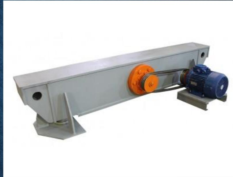
**Вибротумба** предназначена для комплектации **вибростолов**, состоящих из двух и более вибротумб, в зависимости от **металлоформ** формуемых железобетонных изделий
