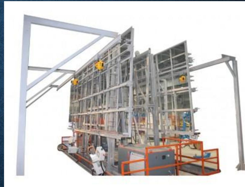
Установка типа СМЖ-56Б, СМЖ-286 Б предназначена для сборки и сварки объемных арматурных каркасов железобетонных изделий, например, каркас трехслойной панели.
