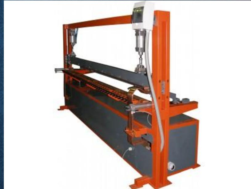
Ручная линия сварки серии РЛ предназначена для организации экономичного производства сварной кладочной сетки.
