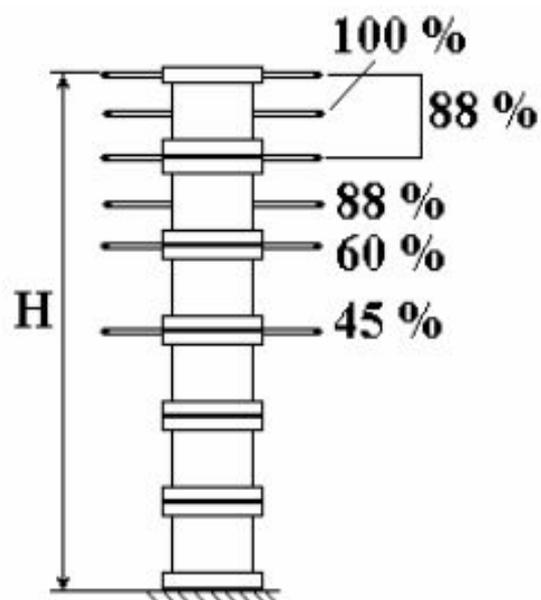
Это приводит к выравниванию поля по длине колонны и повышает напряжение  $E_{кор}$ .
