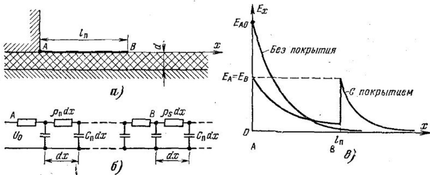
Рис. 7-3. Регулирование электрического поля с помощью полупроводящего покрытия.
