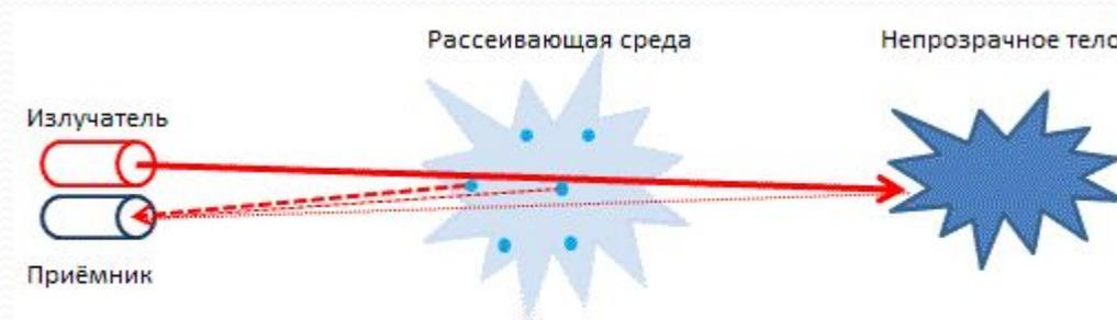
В качестве излучателя используется полупроводниковый лазер ближнего инфракрасного диапазона, работающий в импульсном режиме. Пучок лазера, выходящий из излучателя, отражается от поверхности обследуемого объекта. Отраженный сигнал поступает в приемник сканера, где по задержке времени (импульсный метод) или сдвигу фаз (фазовый метод) между излученным и отраженным сигналом определяется требуемое расстояние.
