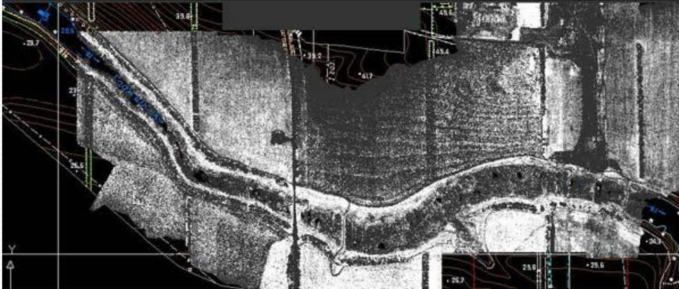
Типовое лазерно-локационное изображение в форме интенсивности.
