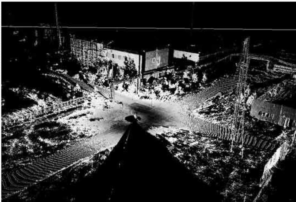
Типовое лазерно-локационное изображение в дальномерной форме.
