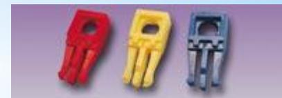
\* Для защиты стационарного оборудования от опасных напряжений и токовых перегрузок в кроссах предусмотрена установка на линейной стороне комплексной защиты, рассчитанной на одновременную защиту по току и напряжению одной пары с индикацией срабатывания разрядника - МЗК, или отдельной защиты в виде группового модуля защиты по напряжению МЗН, одновременно защищающего 10 пар.
