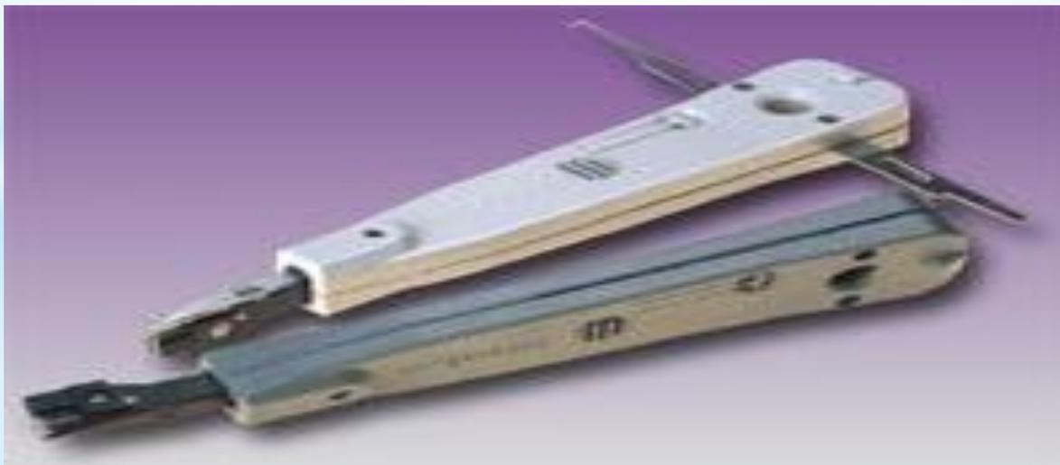
\* Для разделки провода ТРП перед врезкой применяется специальный инструмент для разделки ТРП..
