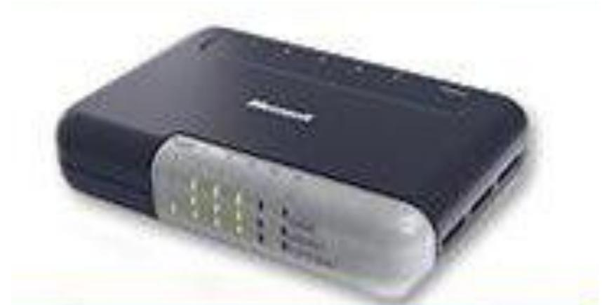
Маршрутизатор (*router*) - это коммуникационное оборудование, которое обеспечивает выбор маршрута передачи данных между несколькими сетями, имеющими различную архитектуру или протоколы. Маршрутизаторы применяют только для связи однородных сетей и в разветвленных сетях, имеющих несколько параллельных маршрутов. Маршрутизаторами и программными модулями сетевой операционной системы реализуются функции сетевого уровня.
