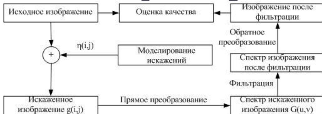
Рисунок 1 – Методика процесса оценки качества алгоритмов фильтрации
