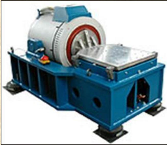
Вибрационные модели данного ряда воспроизводят условия внешней среды в широкой полосе частот и предназначены для испытаний на динамическую прочность и надежность во всех областях применения.
